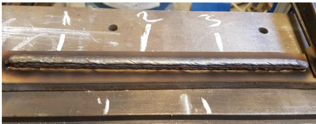
Slika 34. Zid izrađen tijekom provođenja eksperimenta [24]
