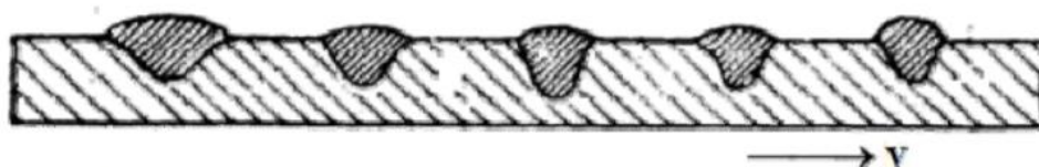
Slika 7. Utjecaj brzine zavarivanja na geometriju zavara [13]
