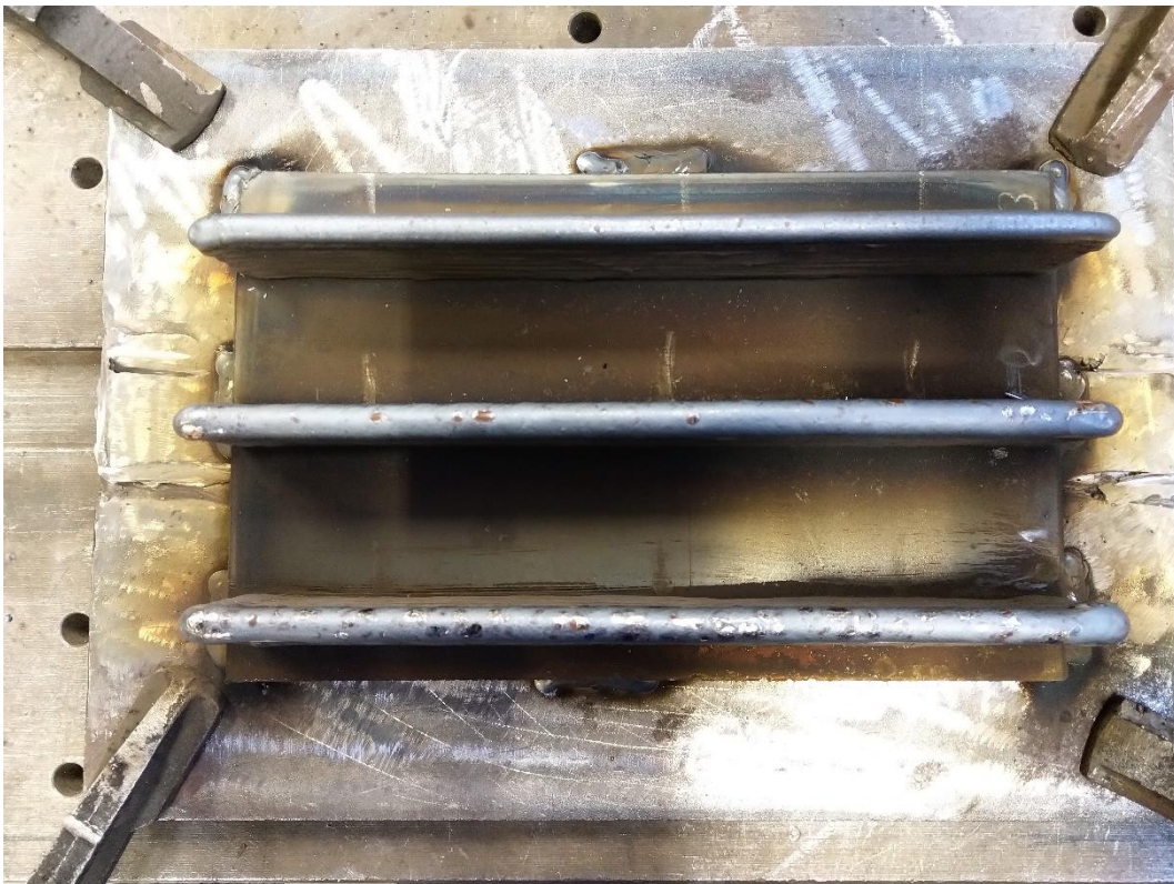
Slika 22. Uzorci izrađeni WAAM postupkom - pogled odozgo
