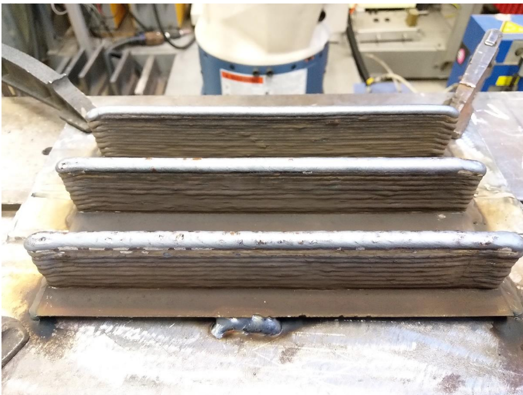
Slika 21. Uzorci izrađeni WAAM postupkom
