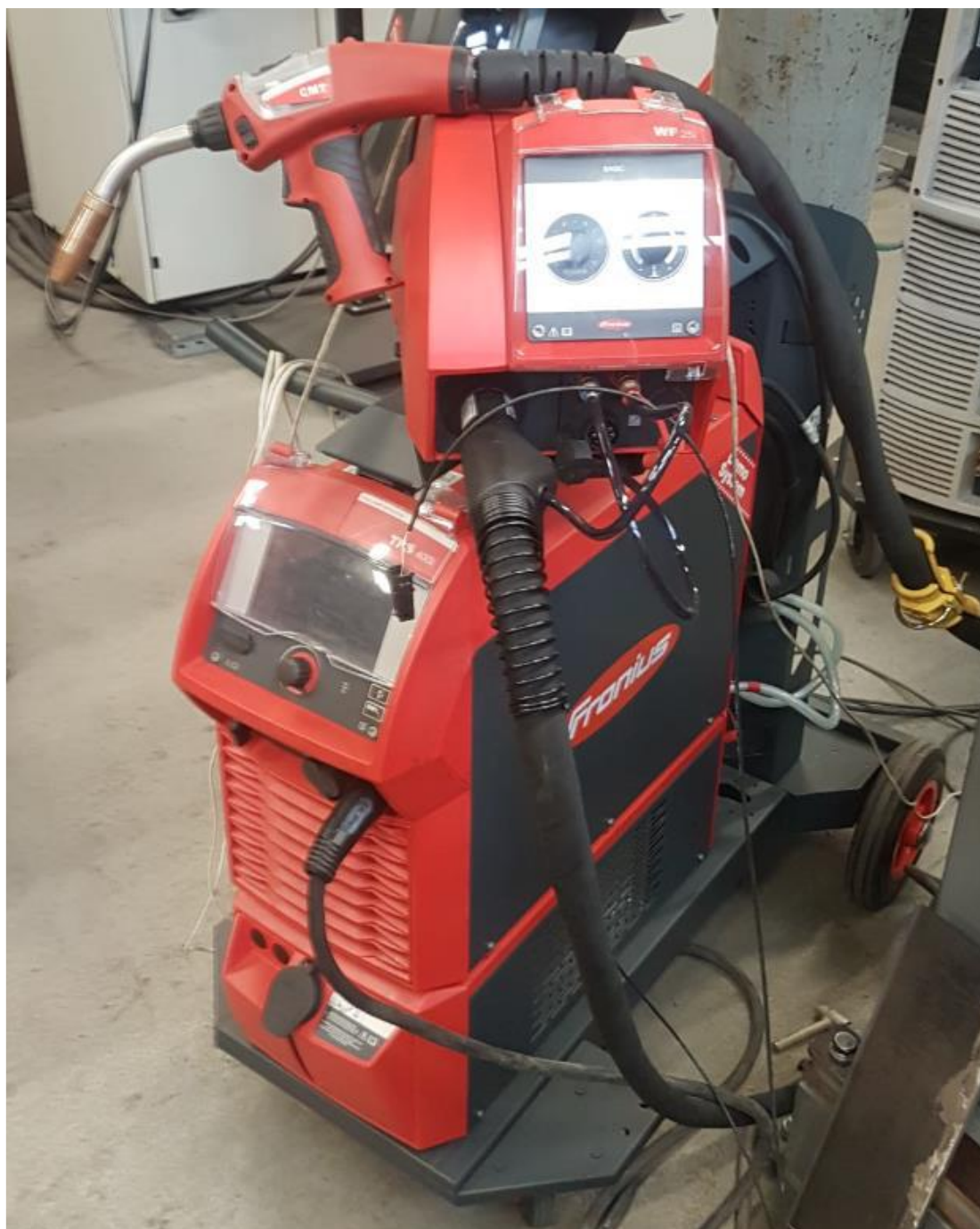
Slika 26. Izvor struje - Fronius TPS 400i CMT [16]
