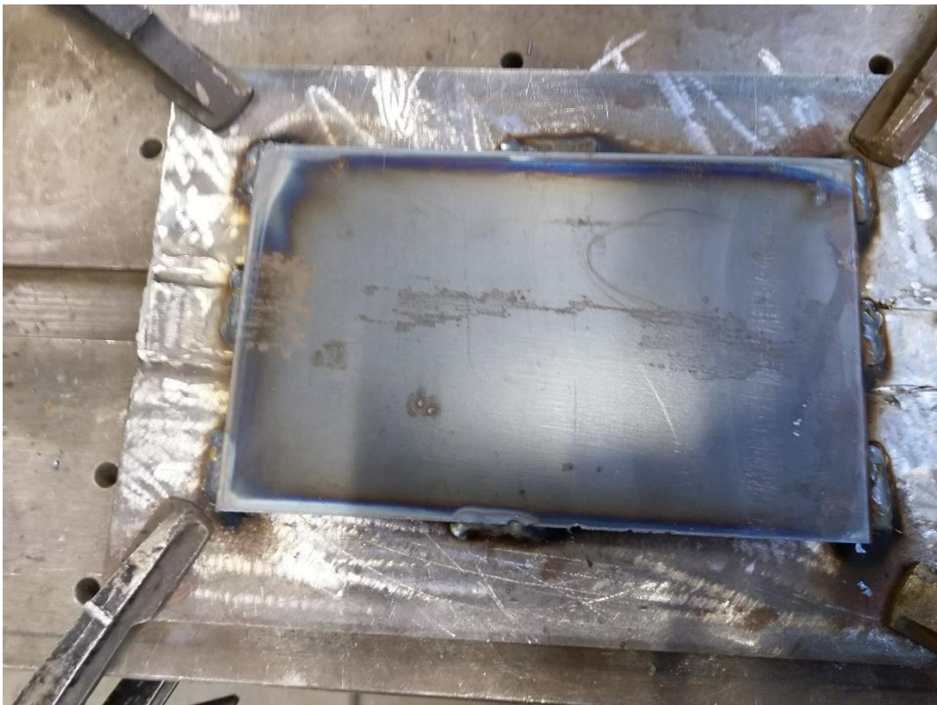
Slika 20. Fiksirana osnovna ploča
