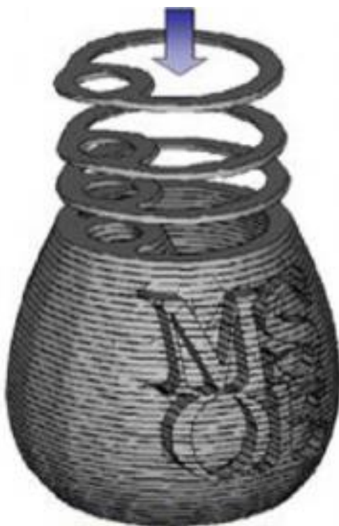
Slika 1. Postupak slaganja slojeva u aditivnoj proizvodnji [4]
