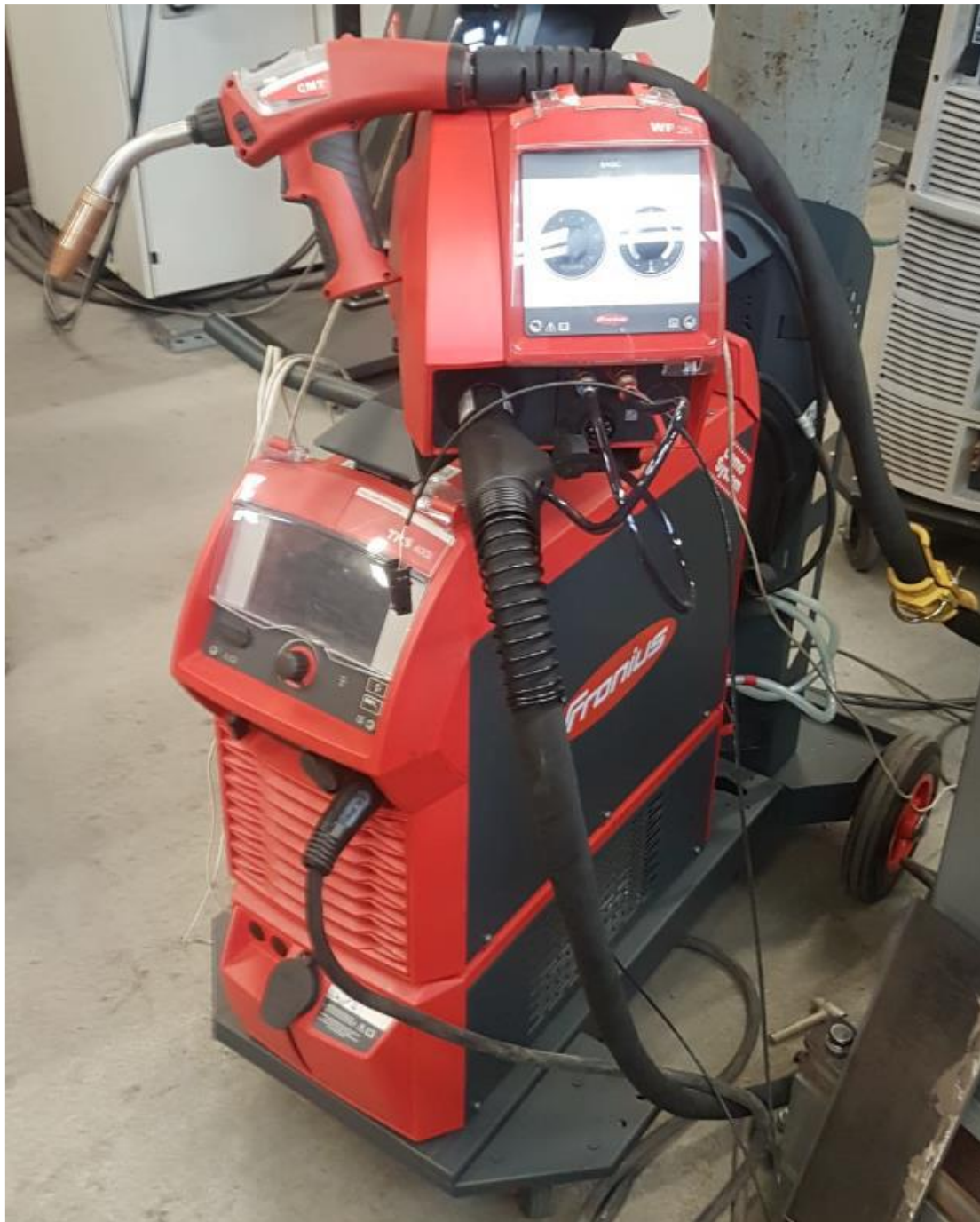
Slika 26. Izvor struje - Fronius TPS 400i CMT [16]
