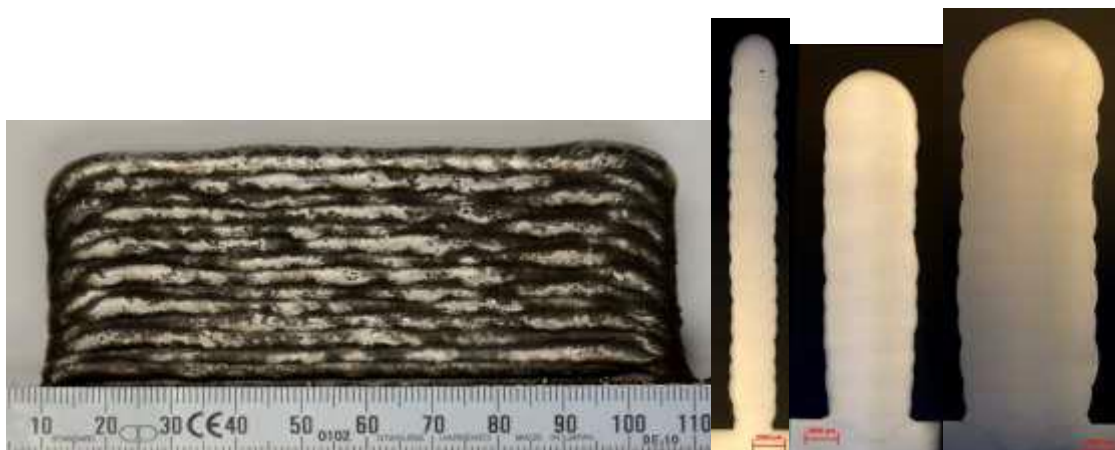
Slika 18. Površina navarenih slojeva (lijevo) i presjeci tri uzorka (desno) [15]
