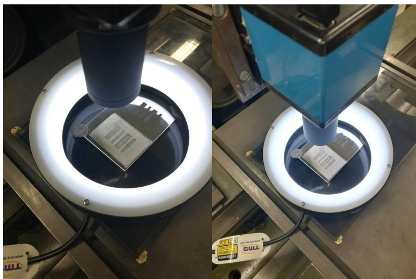
Slika 28 Optičko mjerenje uzorka uz uporabu rasvjete sa osvjetljenjem pod niskim kutom - stražnje osvjetljenje
