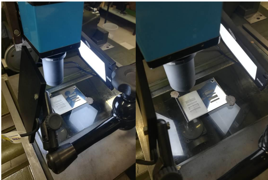
Slika 22 Optičko mjerenje uz uporabu ambijentalne rasvjete
