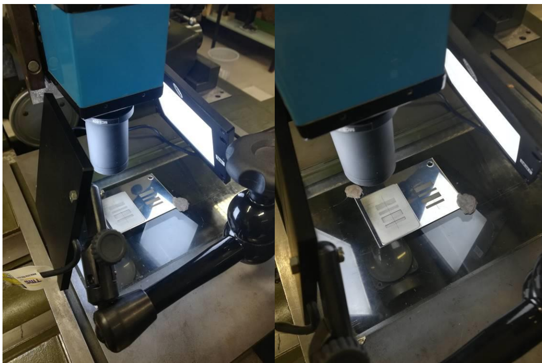
Slika 22 Optičko mjerenje uz uporabu ambijentalne rasvjete
