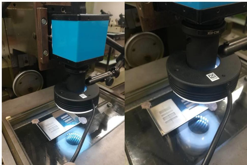
Slika 23 Optičko mjerjenje uz uporabu frontalne rasvjete
