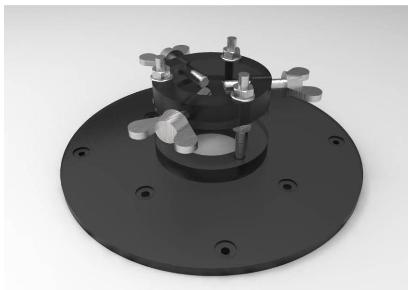
Slika 12 Ilustracija sklopa za prihvati rasvjete sa osvjetljenjem pod niskim kutom
