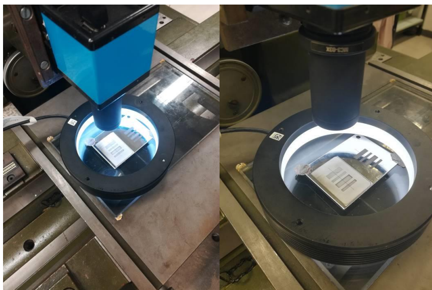
Slika 27 Optičko mjerenje uzorka uz uporabu rasvjete sa osvjetljenjem pod niskim kutom - prednje osvjetljenje
