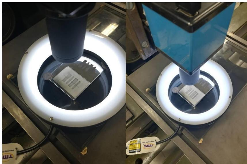
Slika 28 Optičko mjerjenje uzorka uz uporabu rasvjete sa osvjetljenjem pod niskim kutom - stražnje osvjetljenje
