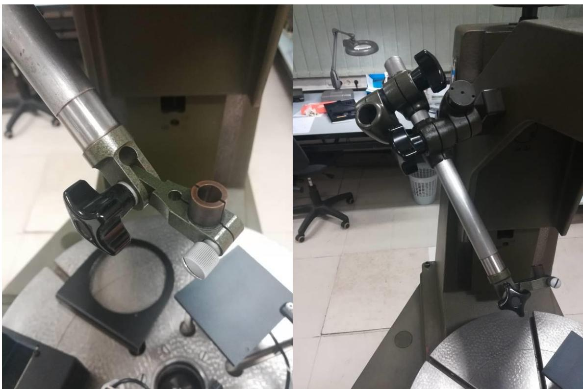
Slika 13 Zglob predviđen za montažu pločaste rasvjete
