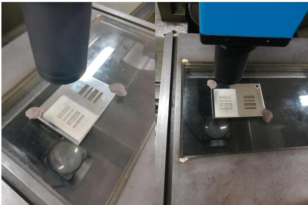
Slika 21 Odabrani uzorak za izvedbu procesa optičkog mjerjenja
