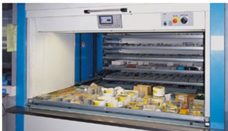
Slika 16. Otvor za izuzimanje VLM-a s mjernim alatima TEH-CUT-a [2]
