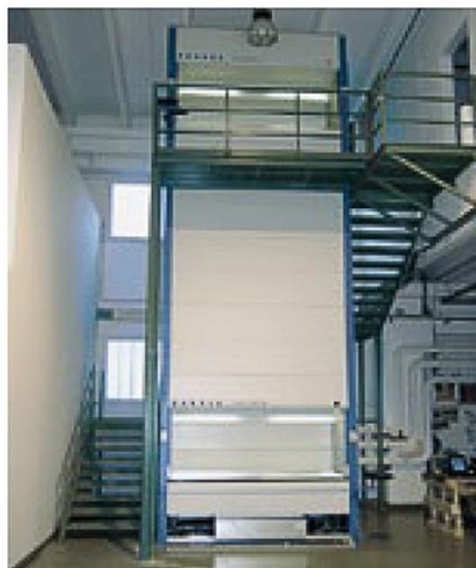
Slika 17. Instalirani VLM s dva otvora [2]
