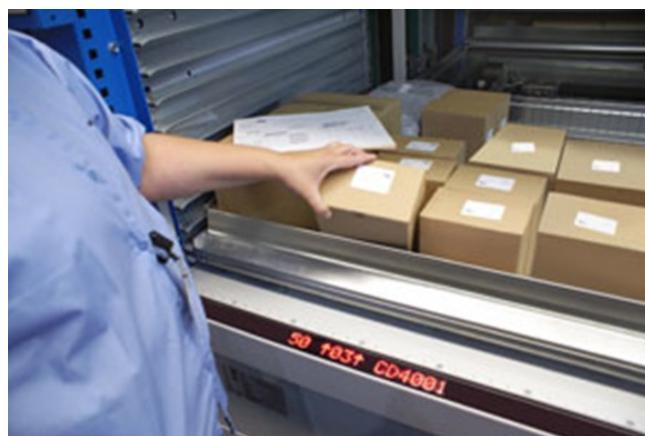
**Slika 12. Svjetlom usmjereno komisioniranje na VLM-u [10]**
