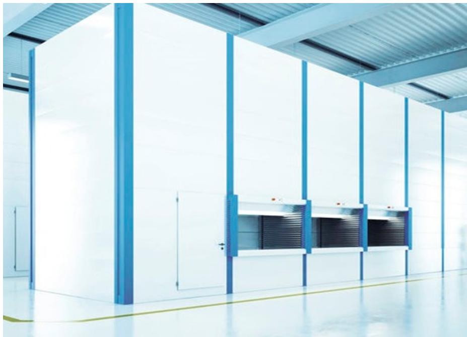
Slika 15. Radna stanica s više modula i jednim ekstraktorom s mogućnošću uzdužnog pomicanja [8]
