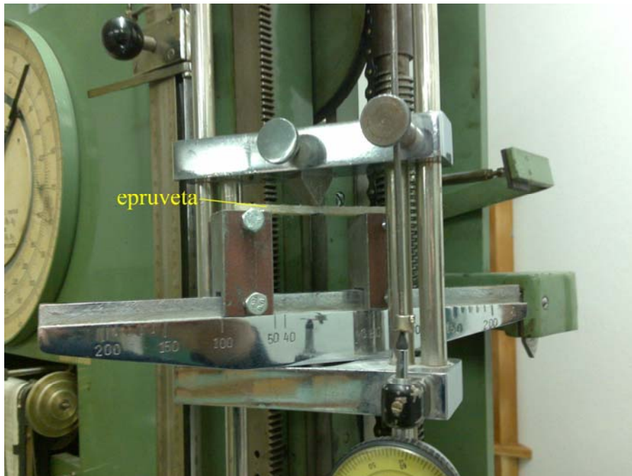
Slika 28. Postavljanje epruvete u napravu za stezanje
