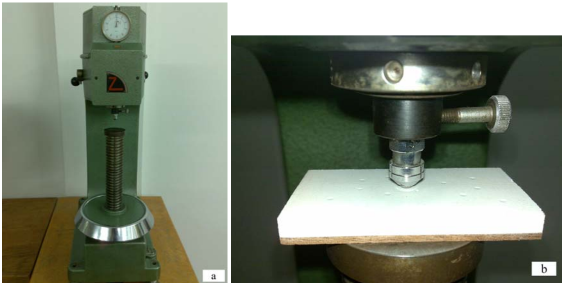
Slika 30. a) Tvrdomjer Zwick 3106, b) Položaj ispitka i način utiskivanja kuglice
