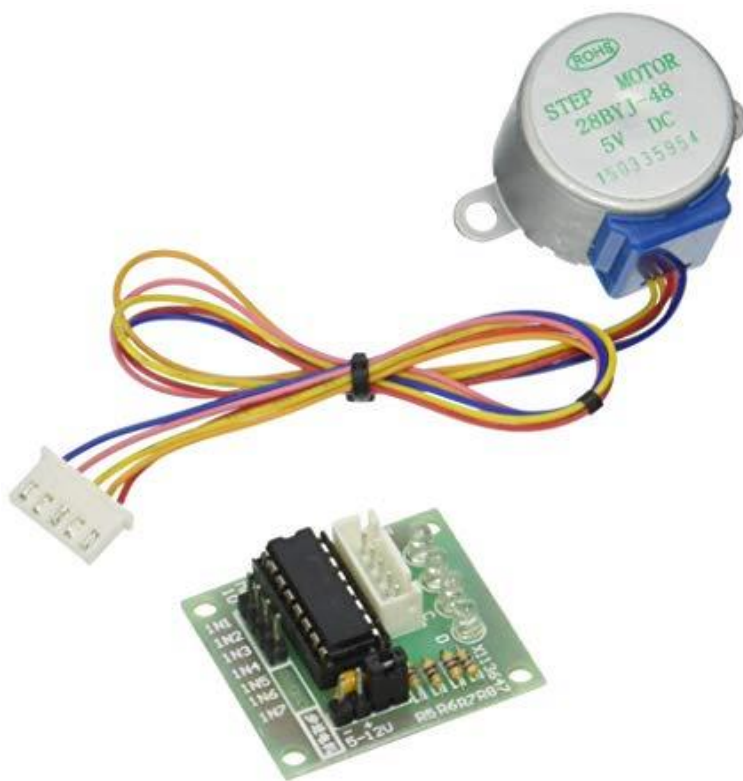
Slika 42. 28BYJ-48 motor s driverom
