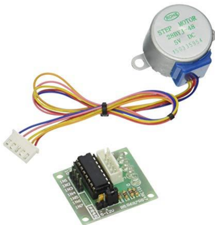
Slika 42. 28BYJ-48 motor s driverom
