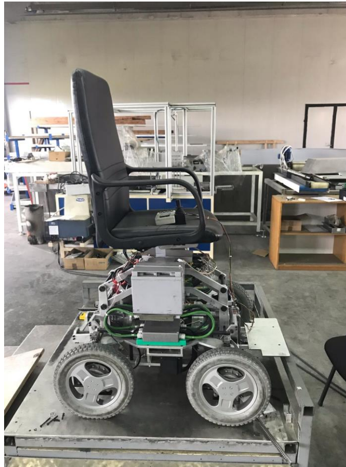
Slika 16. Današnja izvedba KOPACK invalidskih kolica
