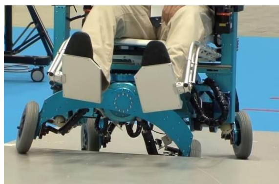
Slika 7. Stabilizacija cijelog sustava tijekom penjanja
