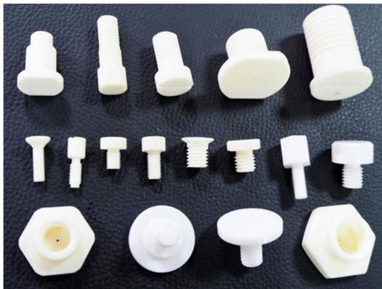
Slika 3. Vijci proizvedeni od \text{Al}_2\text{O}_3 keramike [11]
