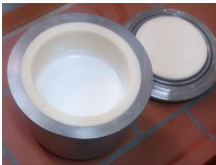
Slika 22. Promiješana smjesa destilirane vode, \text{Al}_2\text{O}_3 praha i disperzanta
