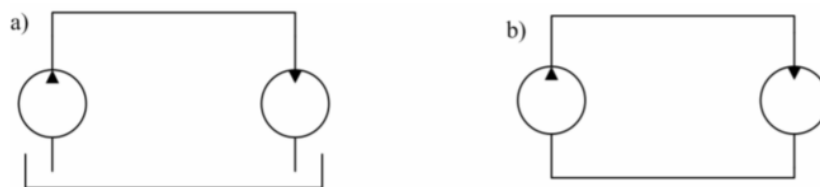
Slika 4. Otvoreni (a) i zatvoreni (b) hidraulički krugovi
