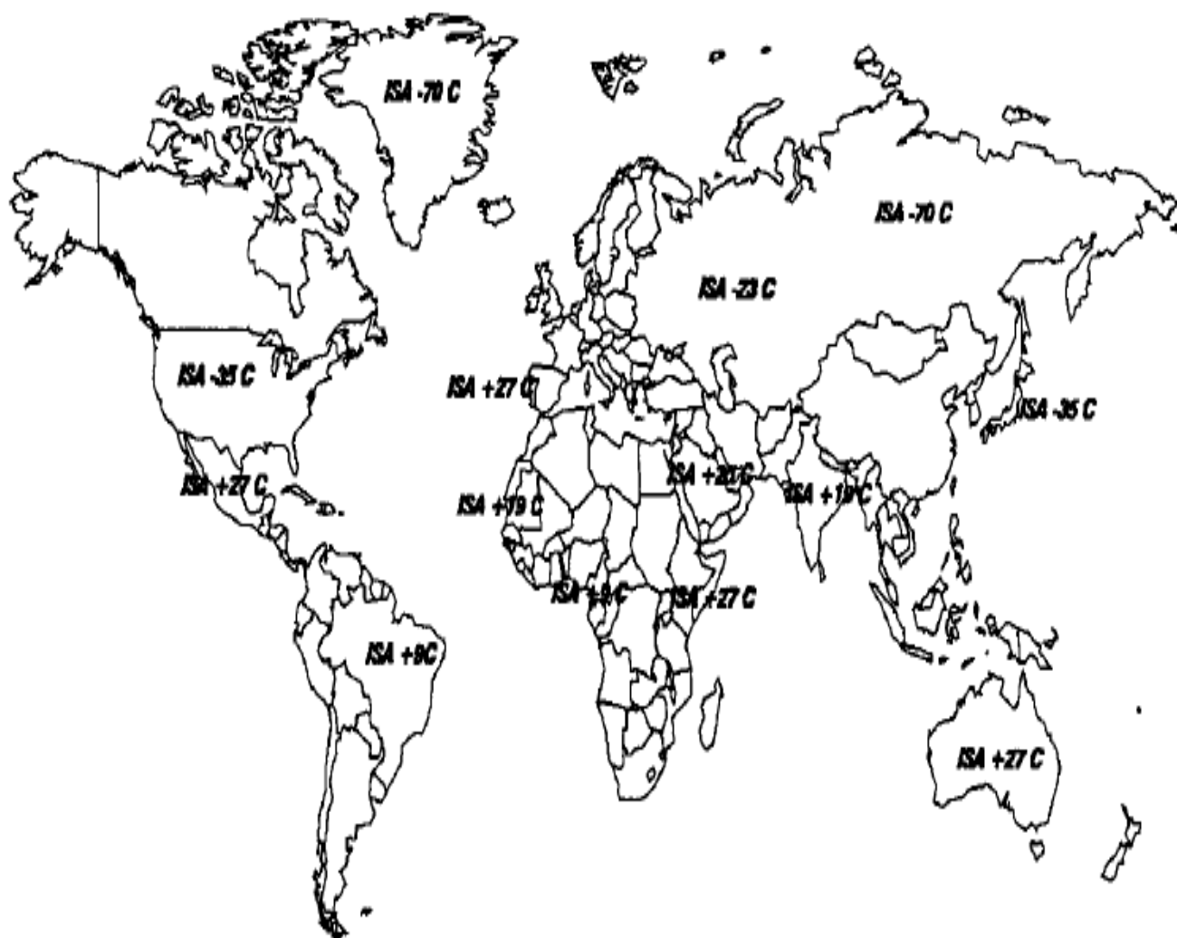
Slika 13 Temperaturna odstupanja u odnosu na osnovni ISA model temperature [8]
