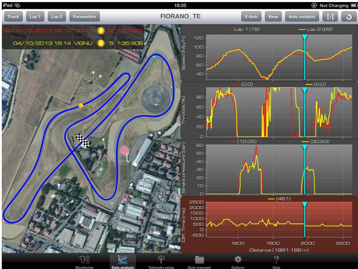
Slika 4. Telemetrija trkaćeg automobila [11]
