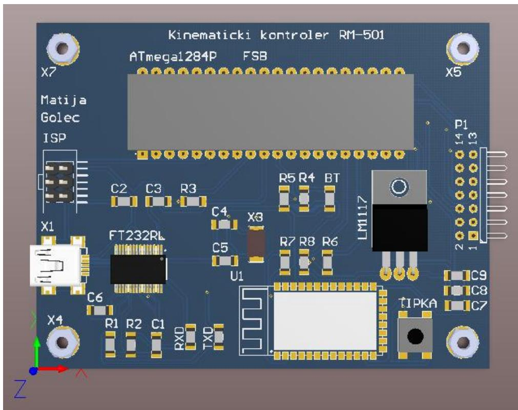
Slika 17. 3D prikaz PCB-a sa svim komponentama
