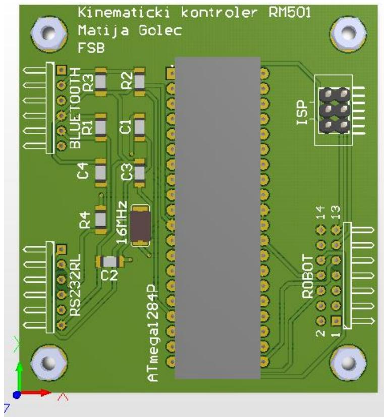
Slika 19. 3D prikaz PCB-a s konektorima za module
