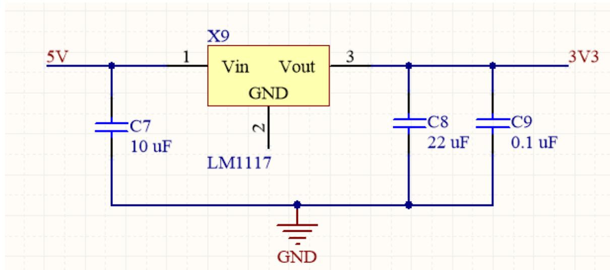
Slika 11. Stabilizator napona
