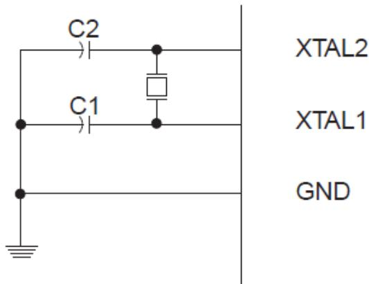
Slika 12. Način povezivanja kvarcnog kristala [5]
