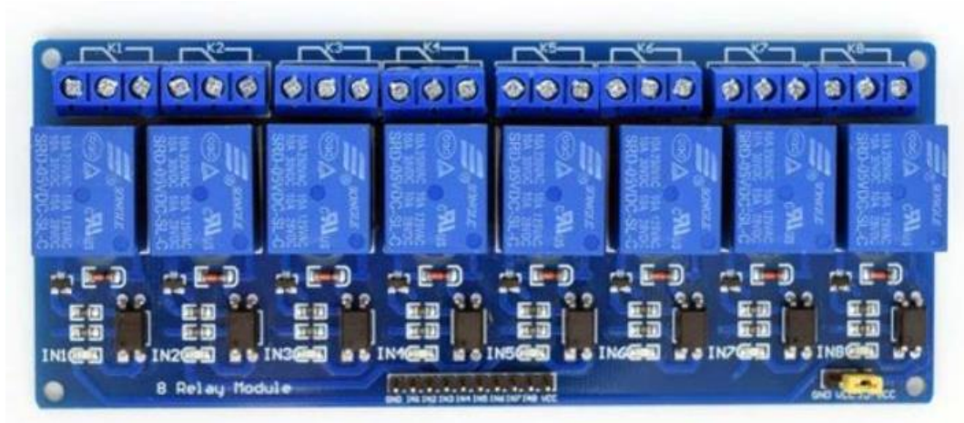
Slika 12. 8-segmentni relejni modul s optokaplerima
