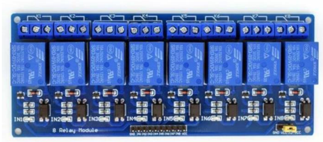
Slika 12. 8-segmentni relejni modul s optokaplerima
