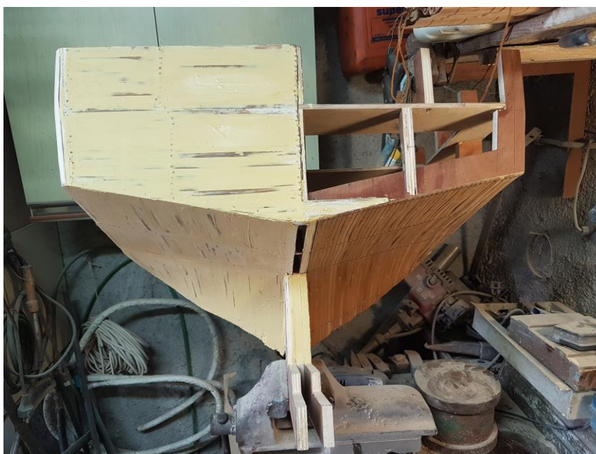
Slika 9. Nanošenje akrilnog kita
