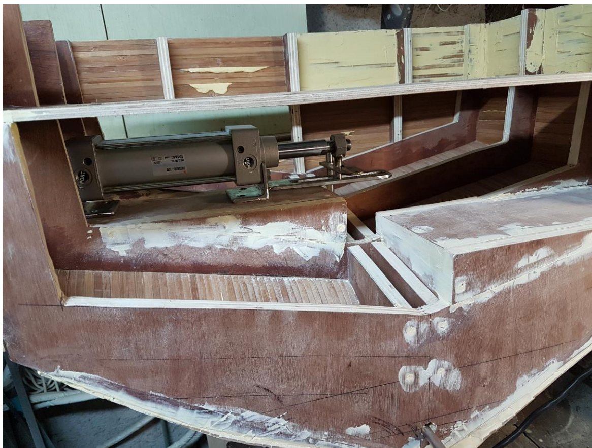
Slika 10. Cilindar postavljen na svoje nosače
