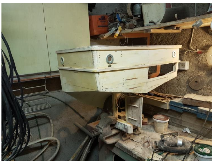
Slika 12. Konstrukcija krme broda
