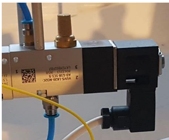
Slika 19. Električki aktivirani 3/2 razvodnik
