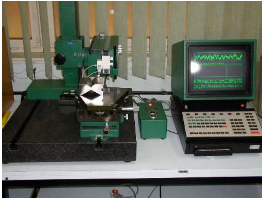
Slika 28. Uređaj za mjerenje hrapavosti i snimanje topografije površine, [30]
