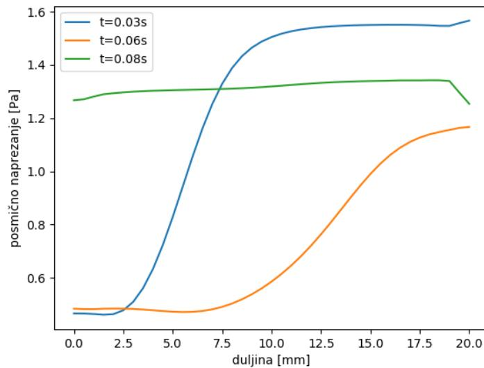
Slika 39. Raspodjela posmičnog naprezanja po duljini unutarnje domene za četvrti slučaj
