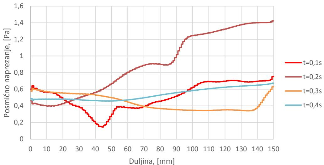
**Slika 12. Raspodjela posmičnih naprezanja po duljini za simulaciju s deformabilnom stijenkom u različitim vremenskim trenutcima**
