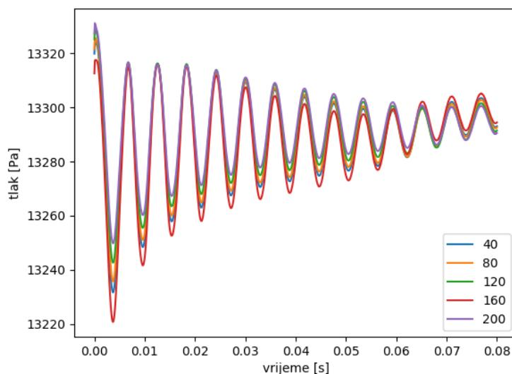
**Slika 45. Tlakovi na ulaznoj površini unutarnje domene fluida**
