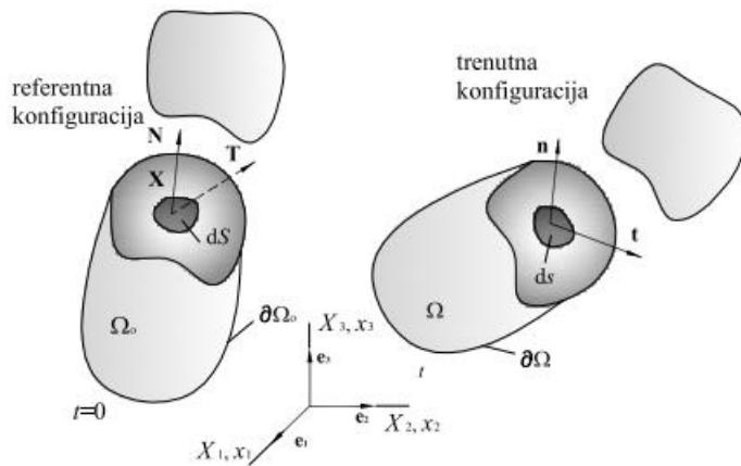
**Slika 5. Vektori naprezanja u referentnoj i trenutnoj konfiguraciji[9]**
