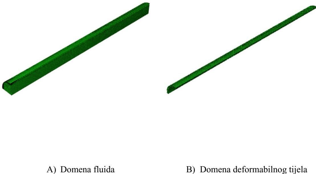
**Slika 10. Prostorna diskretizacija modela za slučaj: A)Domene fluida B) Domene deformabilnog tijela**
