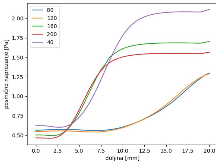
Slika 41. Raspodjela posmičnog naprezanja po duljini unutarnje domene za sve slučajeve za  $t=0,06\text{s}$
