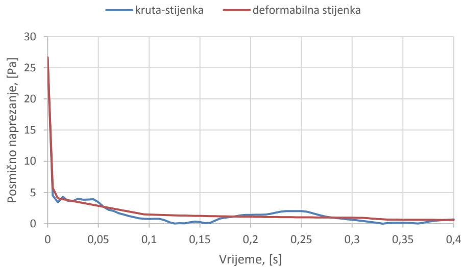
**Slika 15. Usporedba posmičnih naprezanja za krutu i deformabilnu stijenku za različite vremenske trenutke**
