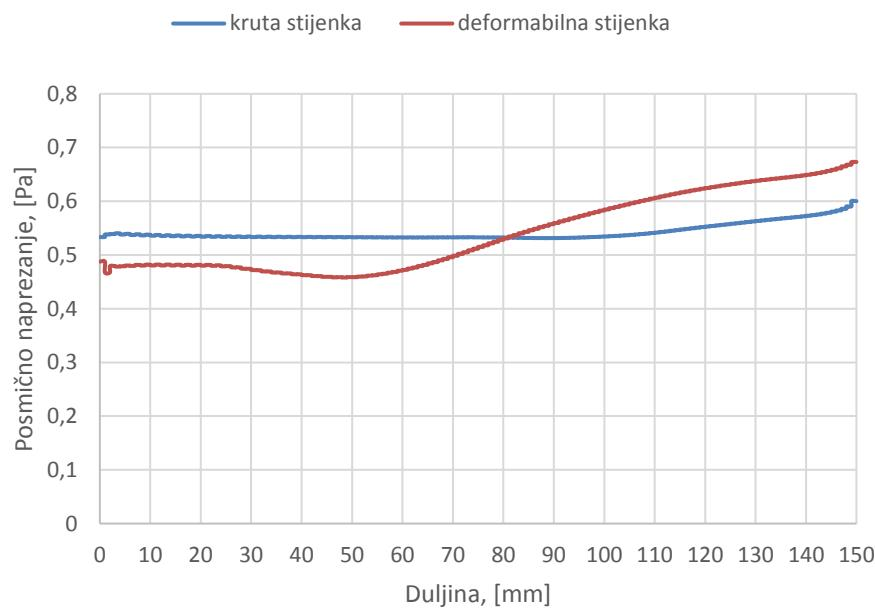
**Slika 14. Usporedba raspodjele posmičnih naprezanja po duljini za simulaciju s krutom i deformabilnom cijevi za trenutak  $t=0,4\text{s}$**
