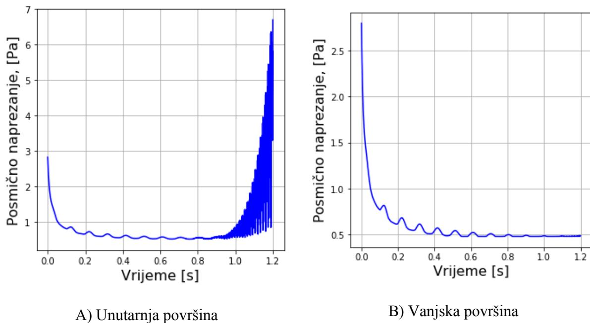
**Slika 27. Maksimalno posmično naprezanje za vanjsku domenu fluida za referentni slučaj:
