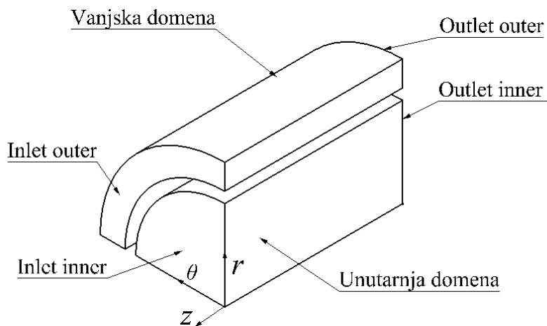
Slika 26. Ulazna i izlazna površina domene strujanja fluida
