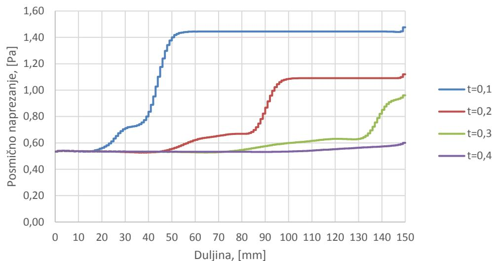
**Slika 13. Raspodjela posmičnih naprezanja po duljini za simulaciju s krutom stijenkom u različitim vremenskim trenutcima**
