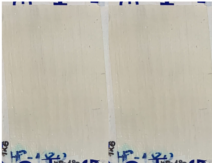
Slika 7.8.2.1. Uzorak prije i nakon izlaganja slanoj komori
