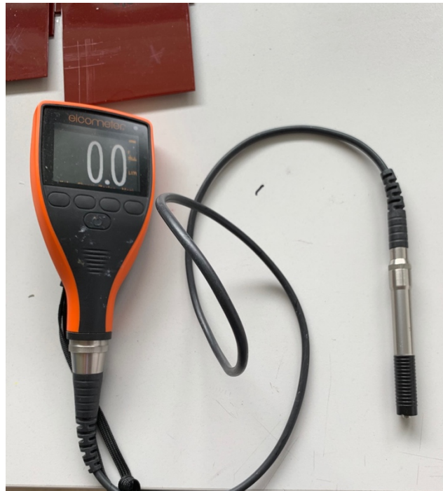
Slika 7.2.2. Uređaj za mjerenje debljine suhog filma „ELCOMETER 456“
