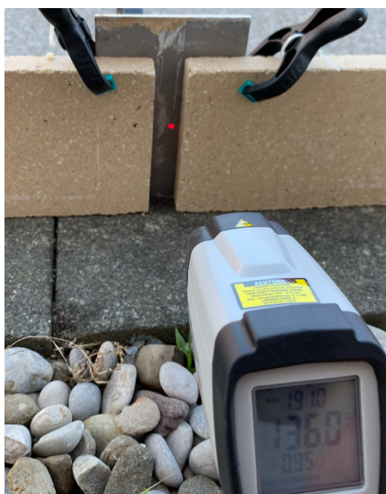
Slika 7.9.2. Mjerenje prirasta temperature pozadine uzorka pirometrom
