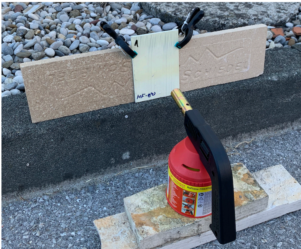
Slika 7.9.1. Izlaganje uzoraka na otvoreni plamen
