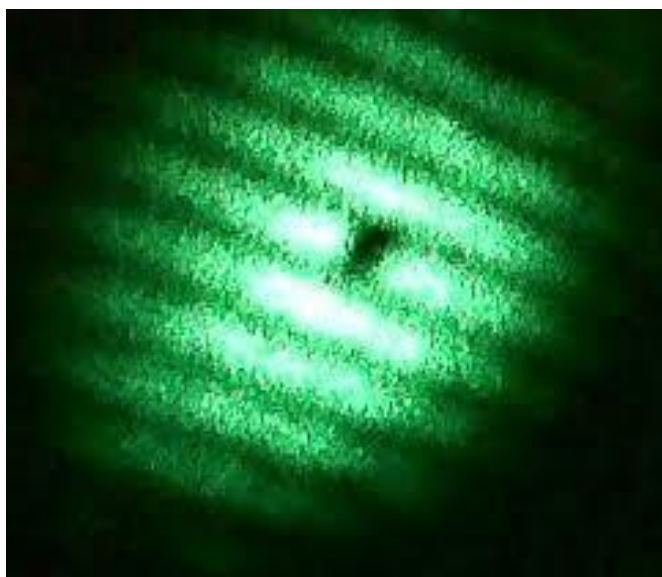
Slika 8 Interferencijske pruge vidljive na zaslonu Twyman-Greenovog interferometra [11]
