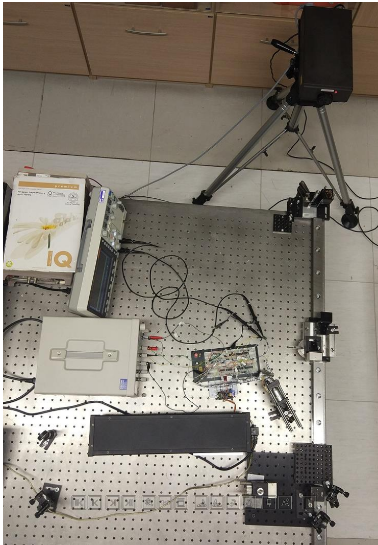
Slika 50 Postav provedenog usporednog mjerenja interferometara
