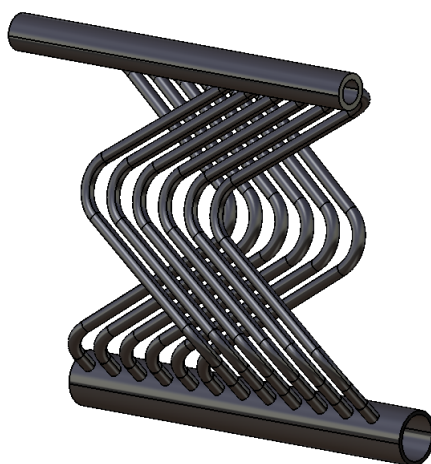
Slika 3.2: Prikaz pola 3D modela donjeg dijela rešetke
