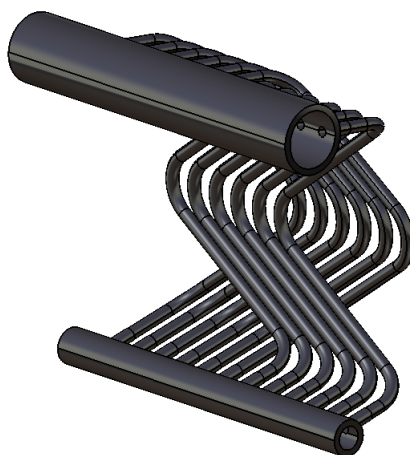
Slika 3.3: Prikaz pola 3D modela gornjeg dijela rešetke
