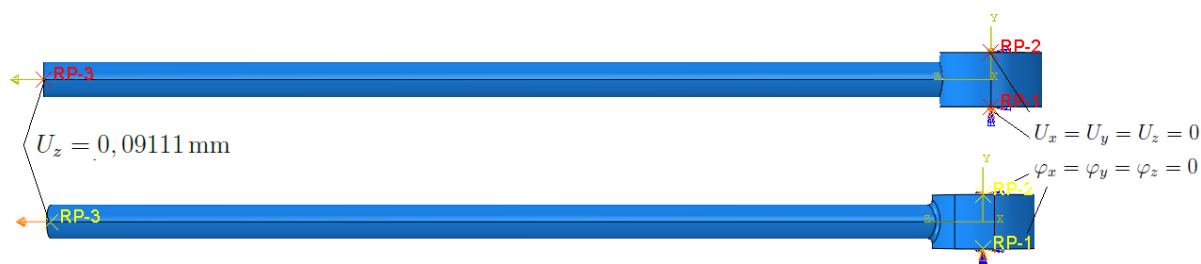
Slika 2.25: Rubni uvjeti za modela izrađenog uz pomoć veze Tie i iz jednog dijela sa zaobljenjem
