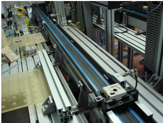
Slika 6.13. Nosač proizvoda na poziciji trake za sklapanje.
