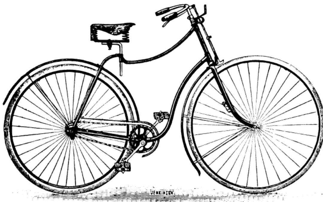
Slika 2. J.K. Starleyjev Rover Safety Bicycle[2]
