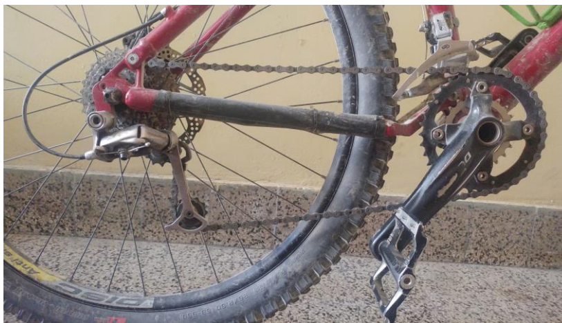
Slika 25. Fotografija prijenosa 2 x 9 short travel trail brdskog bicikla
