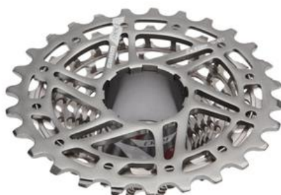
Slika 9. SRAM kazeta iz jednog komada čelika[11]
