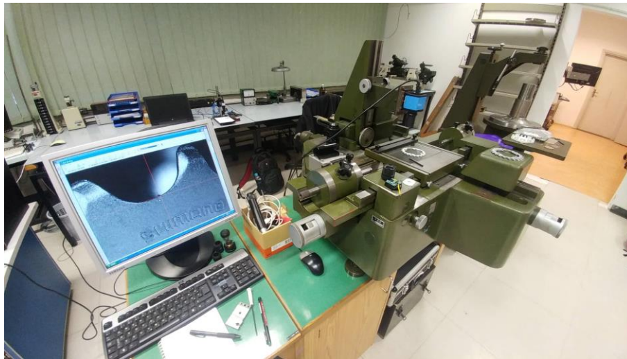
Slika 35. Prikaz alatnog mikroskopa i mjerenja profila zuba
