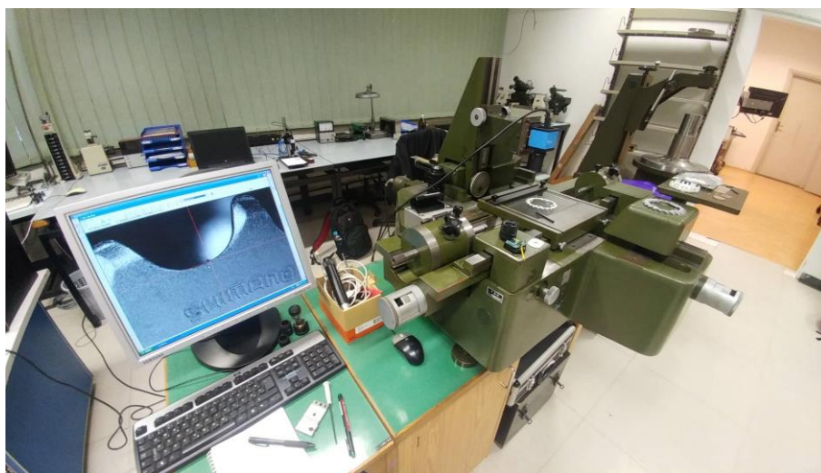
Slika 35. Prikaz alatnog mikroskopa i mjerenja profila zuba
