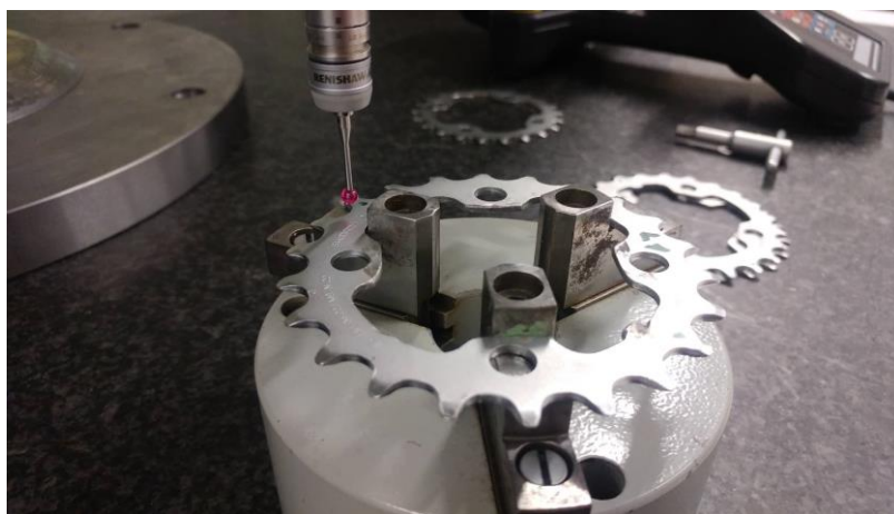
Slika 33. Mjerenje odstupanja od ravnosti lančanika
