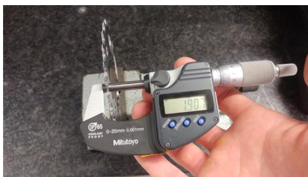
Slika 31. Mjerenje debljine lančanika
