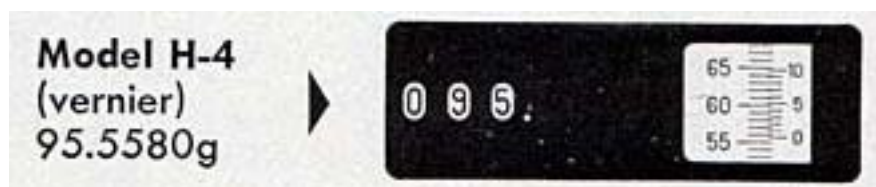
Slika 27. Princip očitavanja rezultata mjerenja [25]
