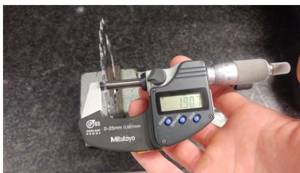
Slika 31. Mjerenje debljine lančanika
