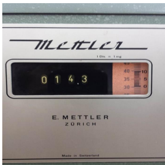
Slika 26. Prikaz očitavanja rezultata s analogne mehaničke vage
