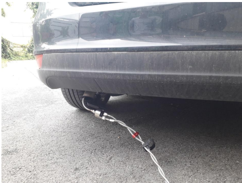
Slika 52. Prihvat sonde za uzorkovanje unutar ispušne cijevi ispitnog vozila
