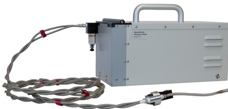
Slika 28. Analizator TSI 3795 za određivanje broja krutih čestica [28]
