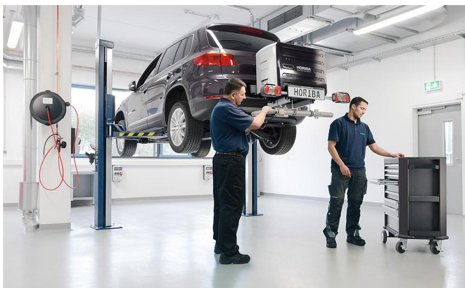
Slika 25. Postavljanje Horiba PEMS sustava na stražnji kraj vozila [26]
