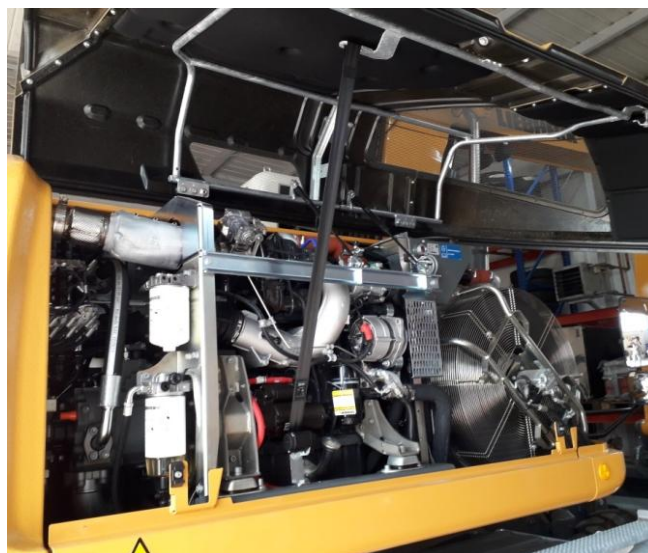
Slika 63. Pogonski sustav bagera Liebherr A914
