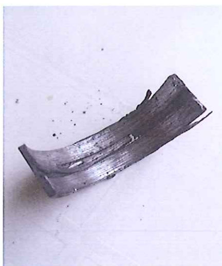
Slika 17. Istrošenost kliznog ležaja 1.4 TDI motora
