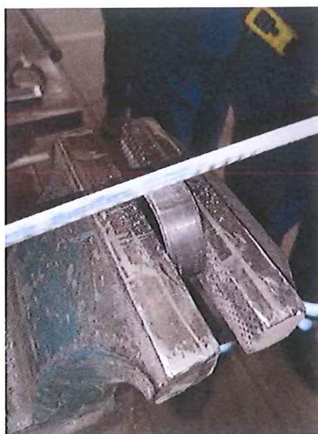
Slika 30. Rezanje ležaja za analizu mikrostrukture
