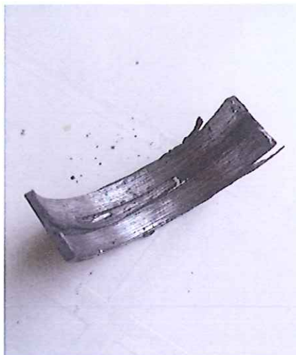
Slika 17. Istrošenost kliznog ležaja 1.4 TDI motora
