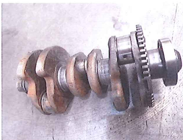
Slika 15. Koljenasto vratilo trocilindarskog motora VAG grupacije, 1.4 TDI
