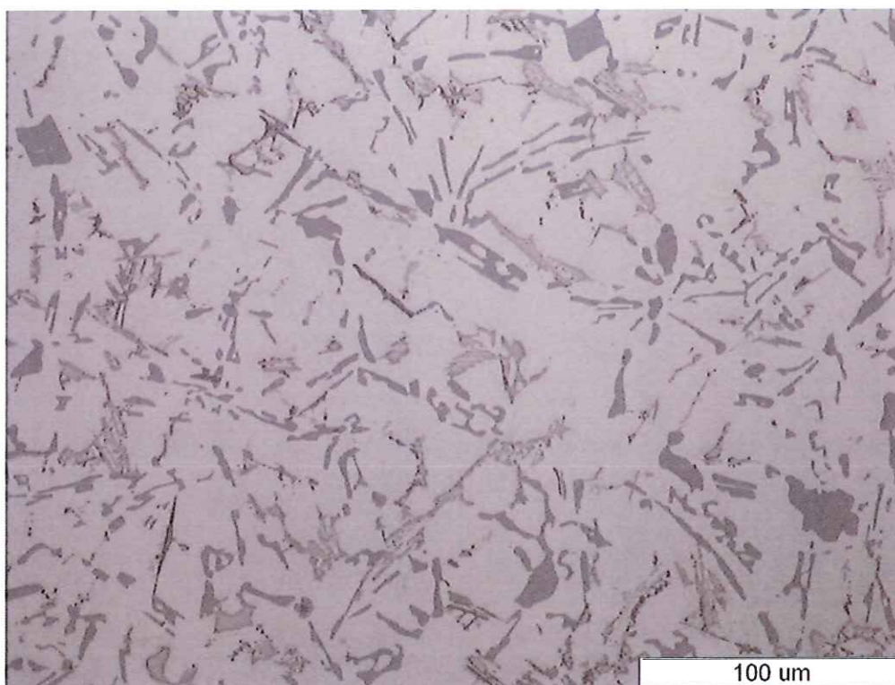
Slika 41. Mikrostruktura klipa na svjetlosnom mikroskopu pod povećanjem 500x
