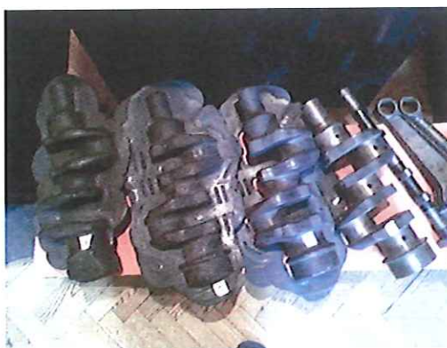
Slika 3. Izrada kovanog koljenastog vratila [6]
