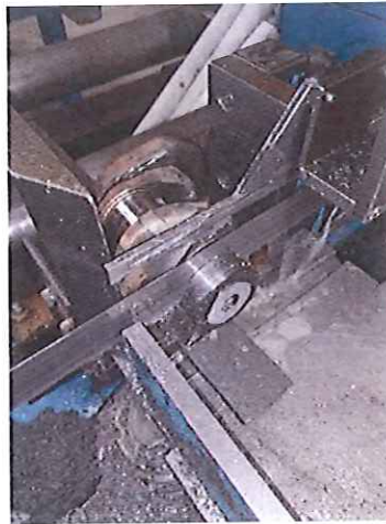
Slika 19. Rezanje uzorka koljenastog vratila za analizu mikrostrukture
