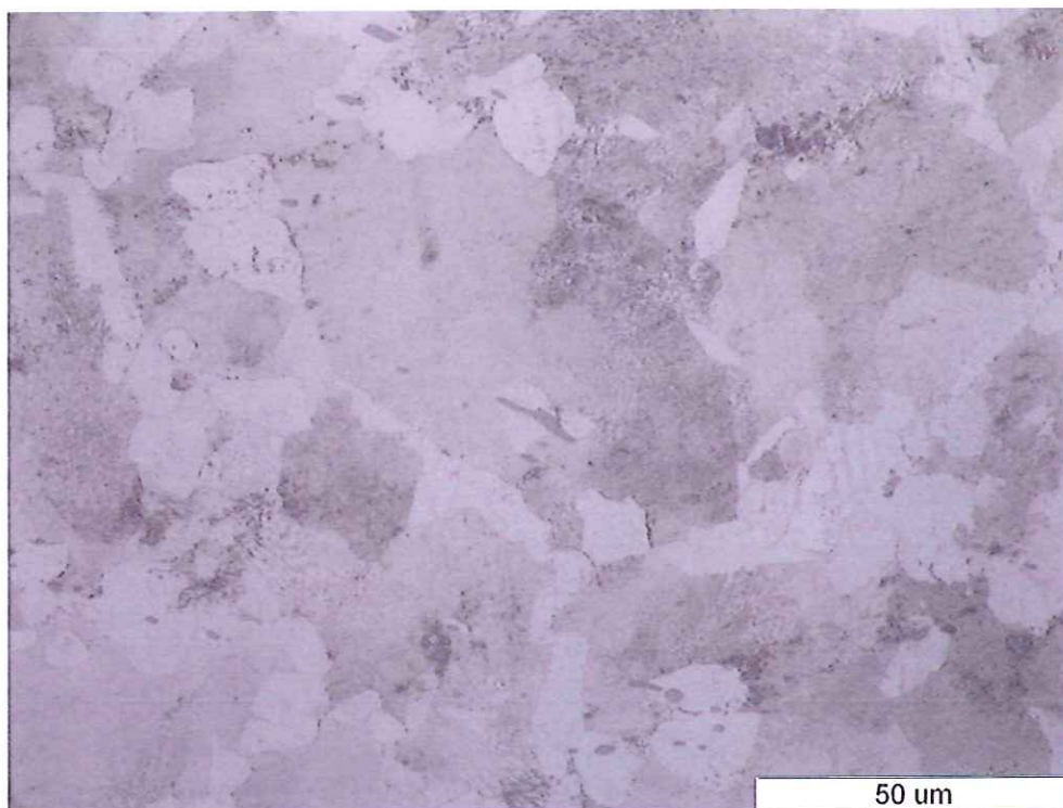
Slika 24. Mikrostruktura dosjednog ležaja koljenastog vratila na svjetlosnom mikroskopu pod povećanjem 1000x
