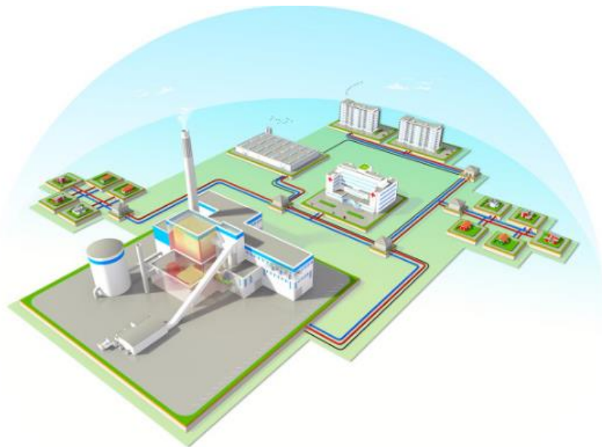
Slika 8. Ilustracija daljinskog sustava grijanja
