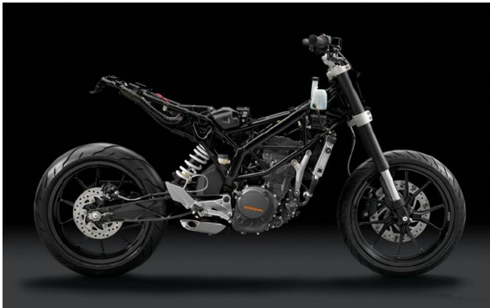
Slika 7: „Trellis“ triangulirana šasija – KTM Duke 200 [1]
