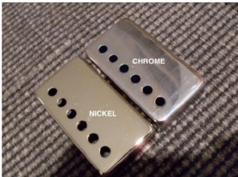
Slika 22: Primjer niklane i kromirane pločice [11]
