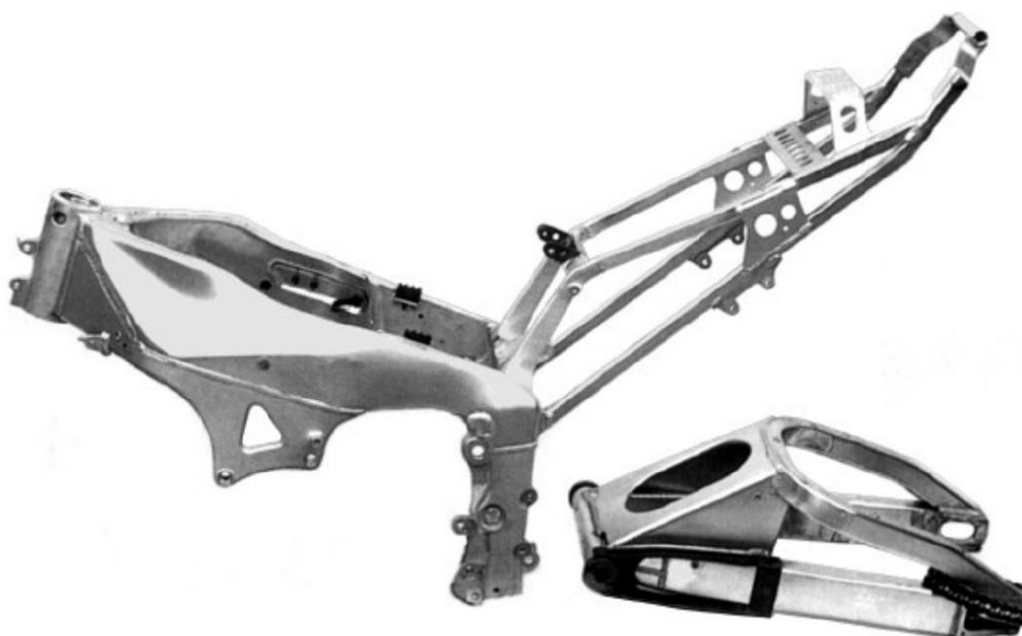
Slika 11: Twin – spar šasija, Yamaha R1 [1]
