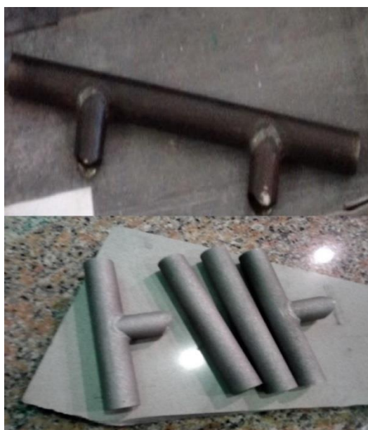
Slika 46: Uzorci prije i nakon rezanja i sačmarenja
