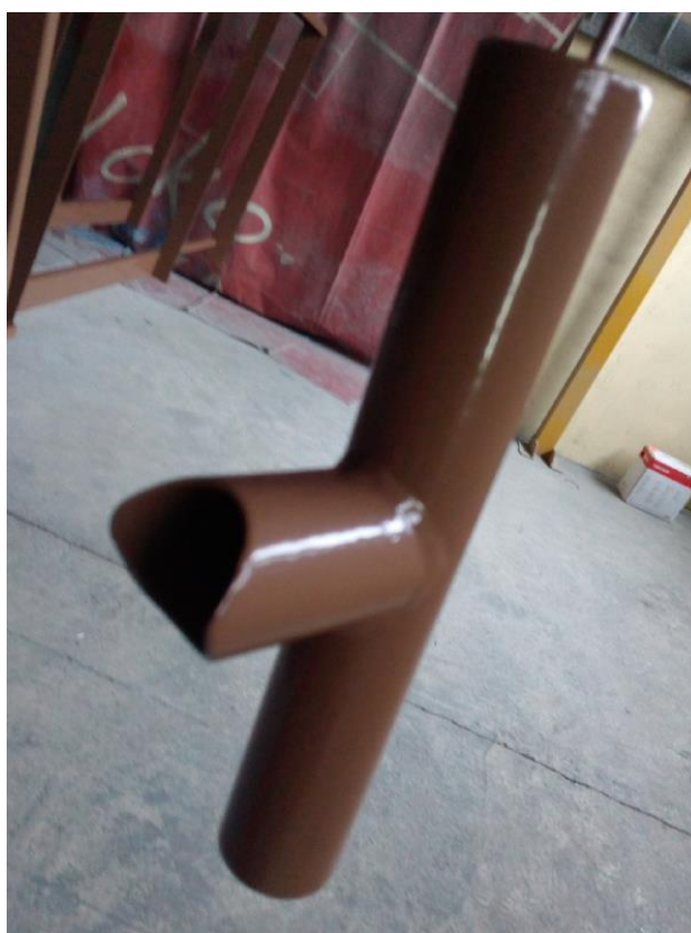
Slika 49: Zaštita postupkom elektrostatskog nanošenja praška
