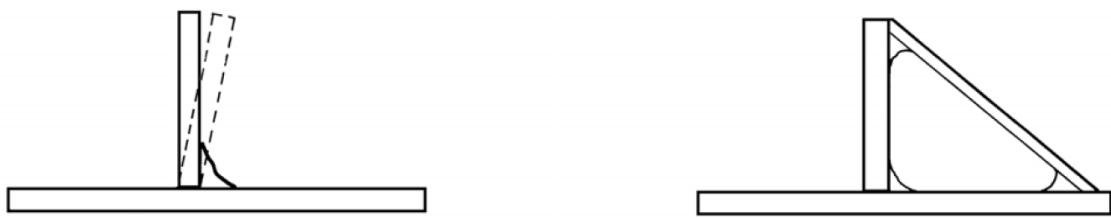
Slika 12: Primjer izbjegavanja distorzije prilikom zavarivanja [4]
