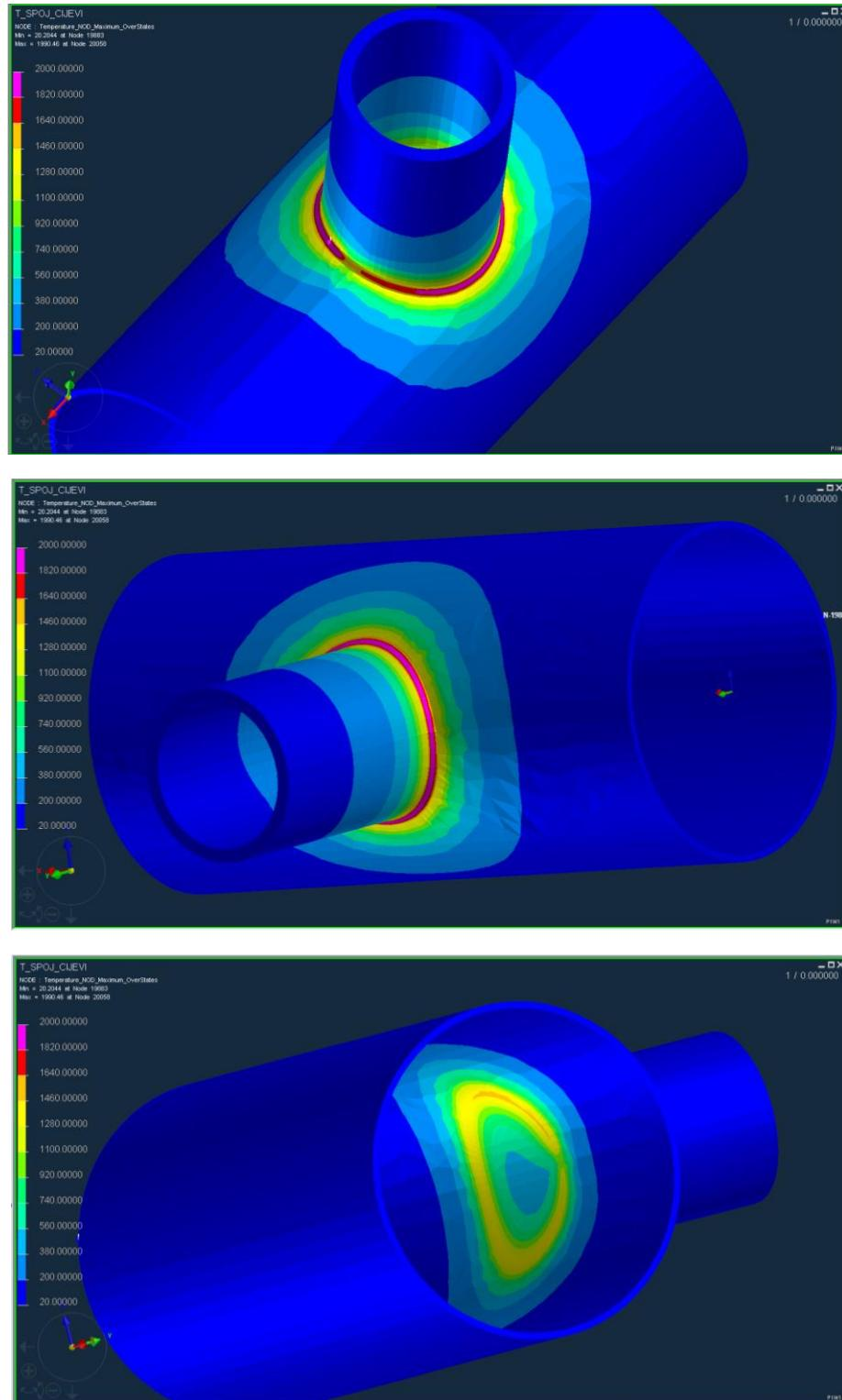
Slika 71: Prikaz maksimalnih temperatura postignutih tijekom zavarivanja
