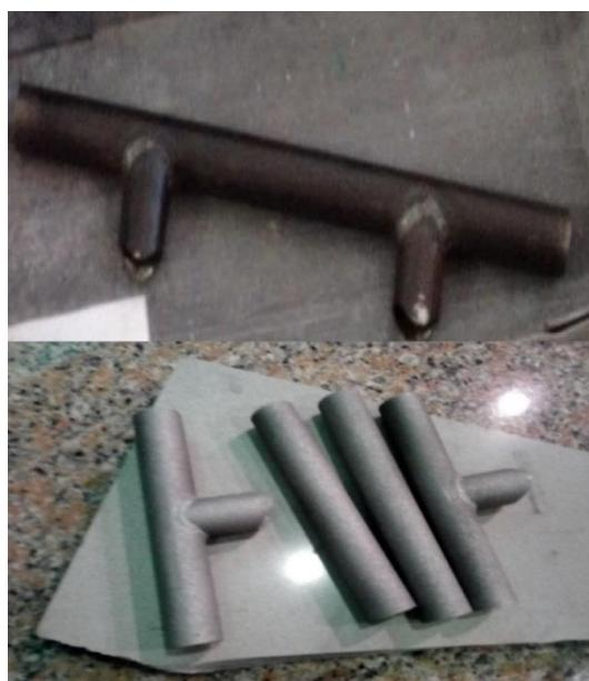
Slika 46: Uzorci prije i nakon rezanja i sačmarenja
