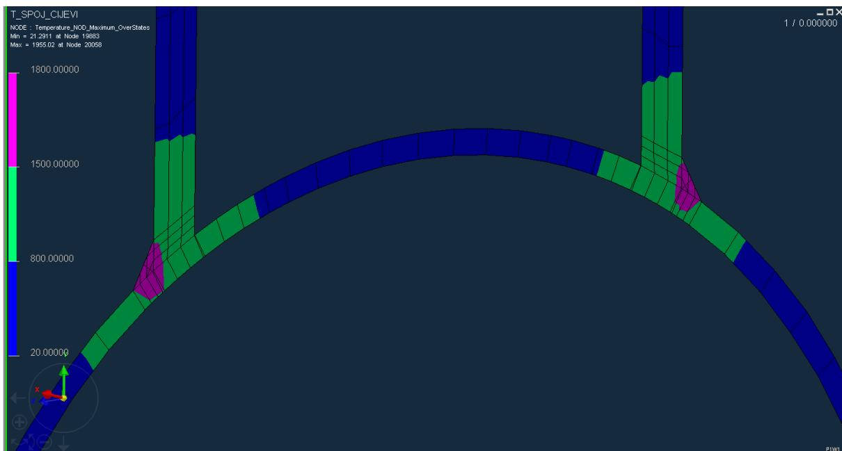
Slika 68: Prikaz presjeka zavara u YZ ravnini
