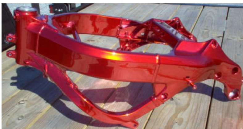
Slika 26: Zaštita šasije praškastim prevlakama [16]
