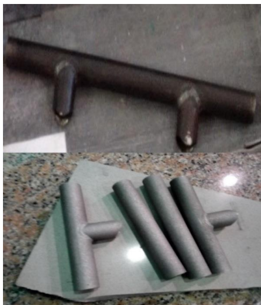
Slika 46: Uzorci prije i nakon rezanja i sačmarenja
