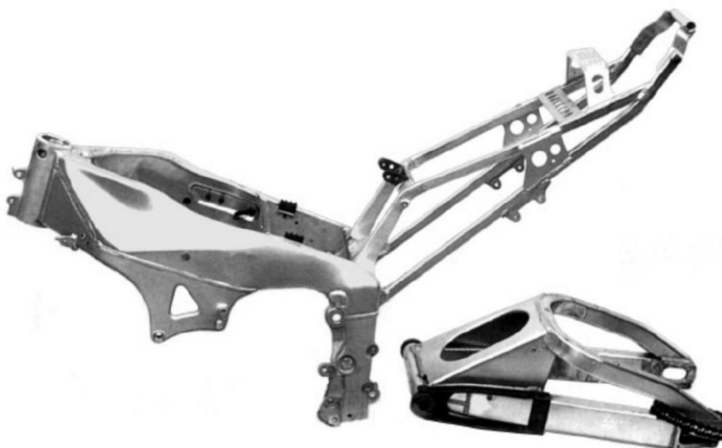
Slika 11: Twin – spar šasija, Yamaha R1 [1]
