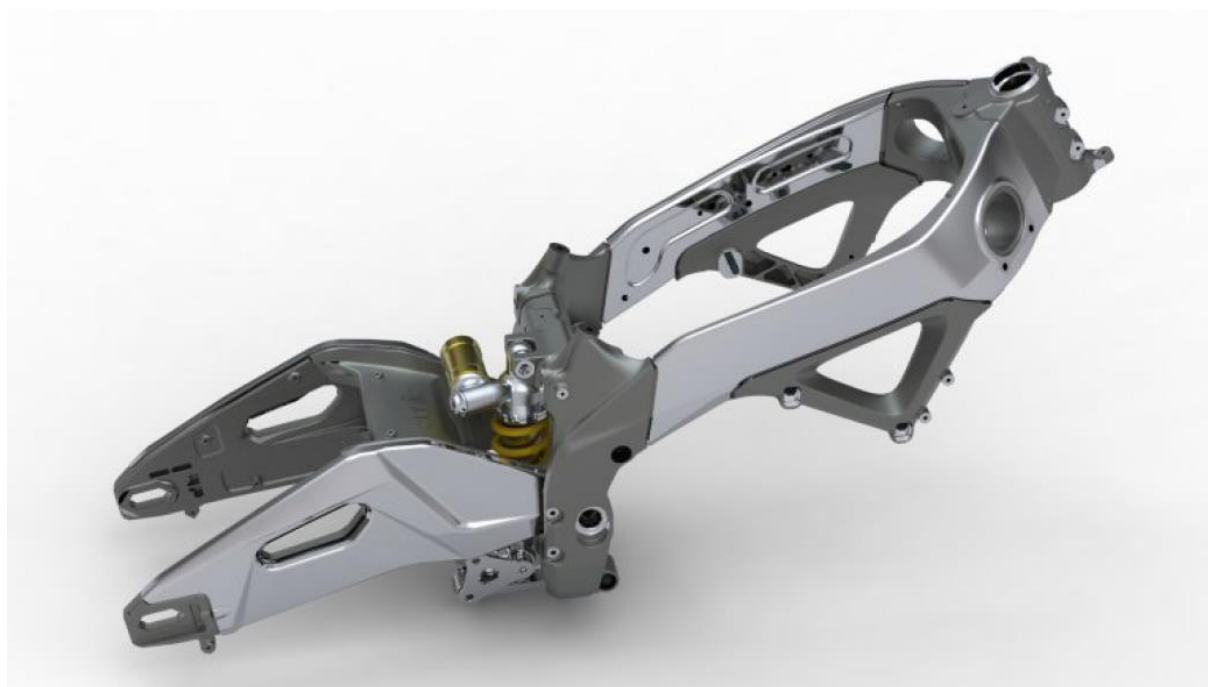
Slika 19: Aluminijska šasija izvedena s mnogo vijčanih spojeva [9]
