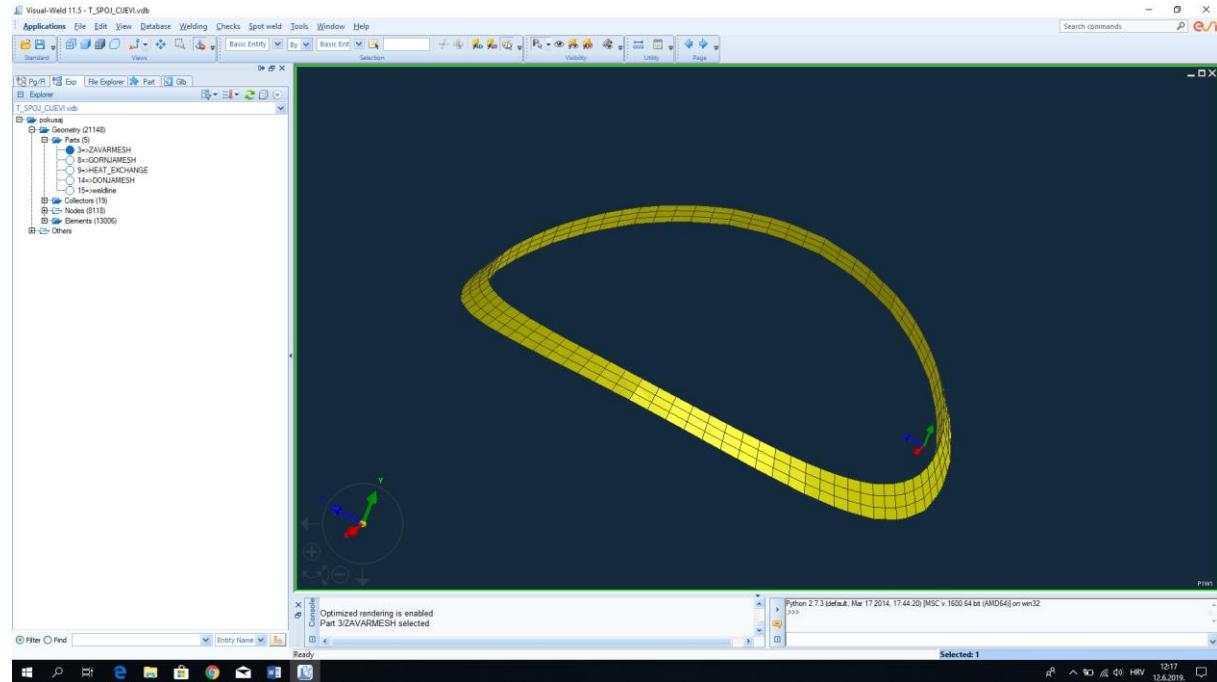
Slika 50: Prikaz mreže elemenata napravljenje na zavaru
