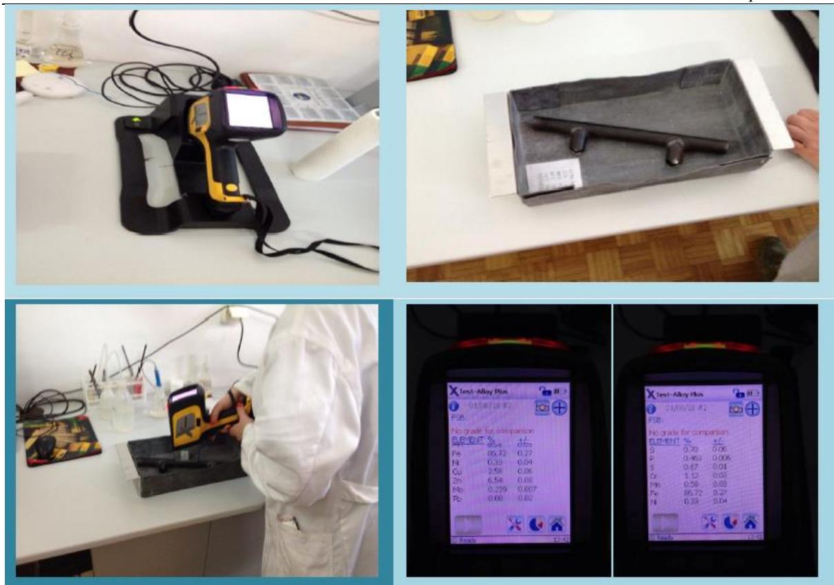
Slika 36: Etape ispitivanja kemijskog sastava
