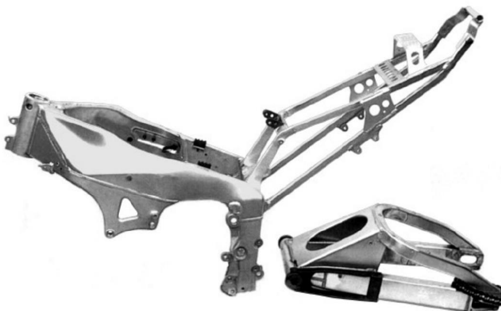
Slika 11: Twin – spar šasija, Yamaha R1 [1]
