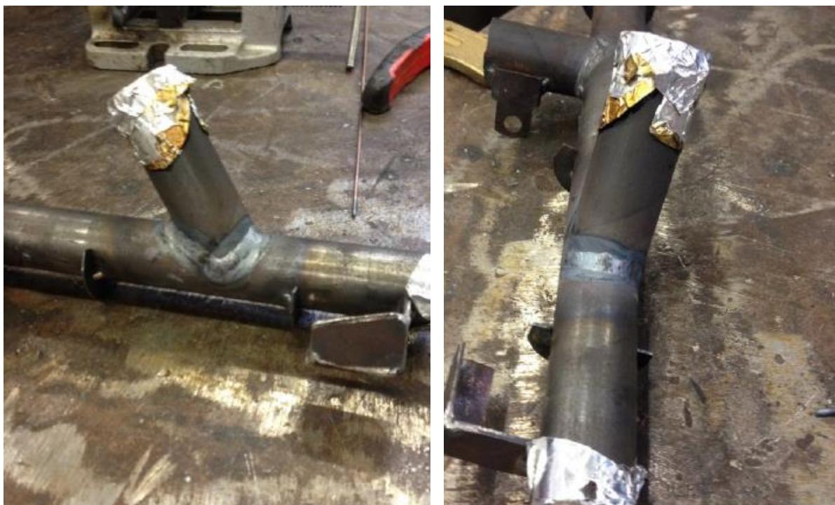
Slika 42: Zavareni spoj netom nakon zavarivanja
