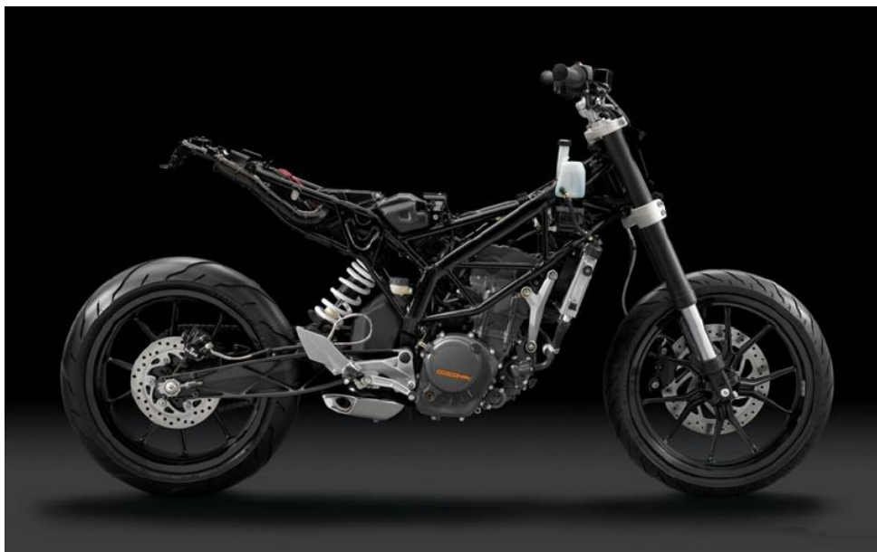
Slika 7: „Trellis“ triangulirana šasija – KTM Duke 200 [1]
