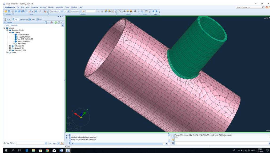
Slika 53: Prikaz mreže elemenata na cijelom spoju
