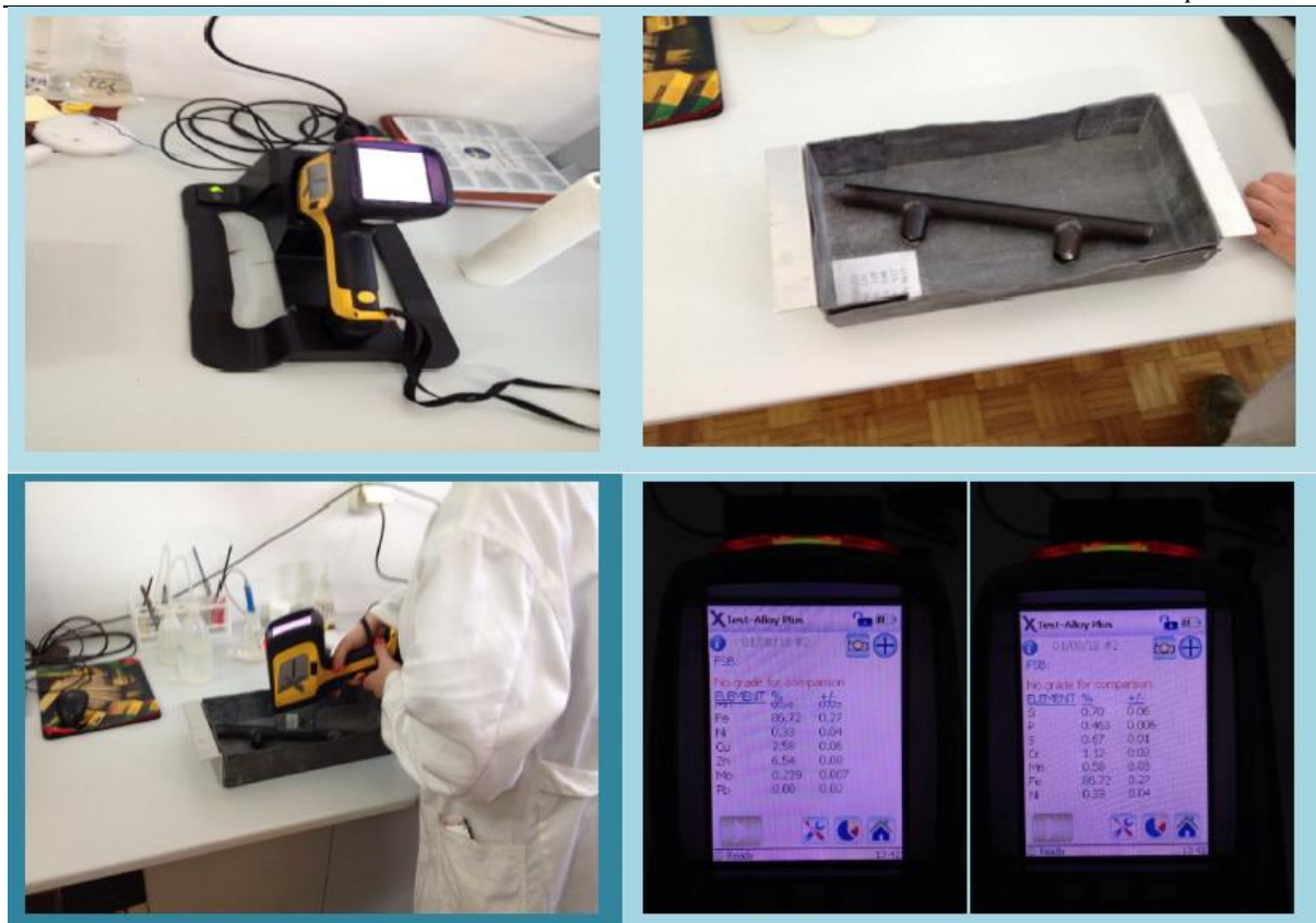
Slika 36: Etape ispitivanja kemijskog sastava
