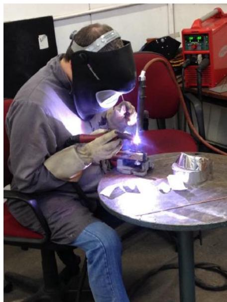
Slika 41: Izvođenje zavarivanja
