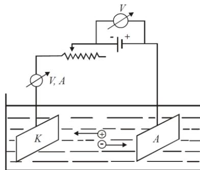
Slika 21: Shema uređaja za galvanizaciju – niklanje i kromiranje [7]
