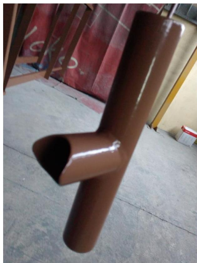
Slika 49: Zaštita postupkom elektrostatskog nanošenja praška
