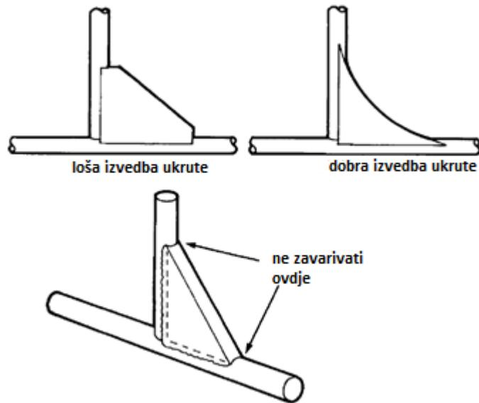
Slika 14: Pravilna izrada ukruta i zavarivanje istih [4]
