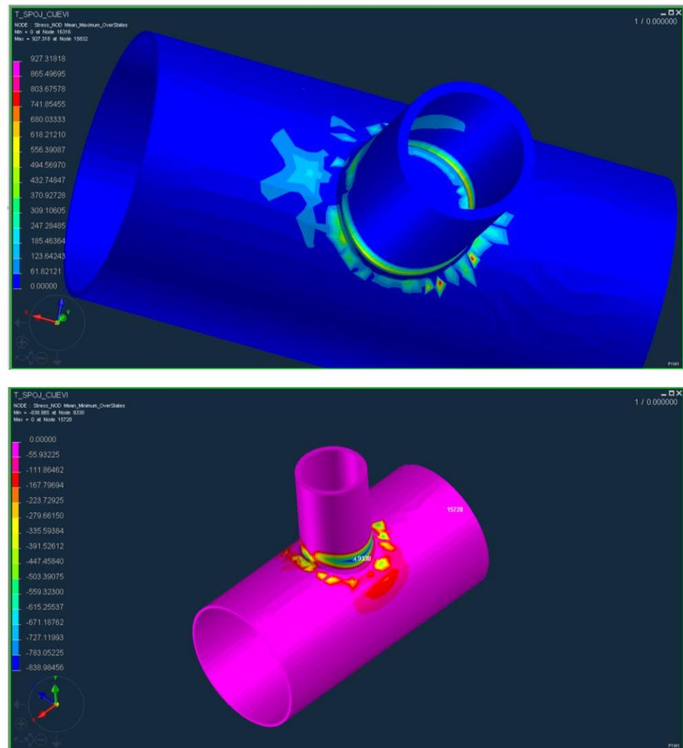
Slika 74: Prikaz naprezanja prema teoriji srednjih naprezanja (vlak-gore; tlak-dolje)
