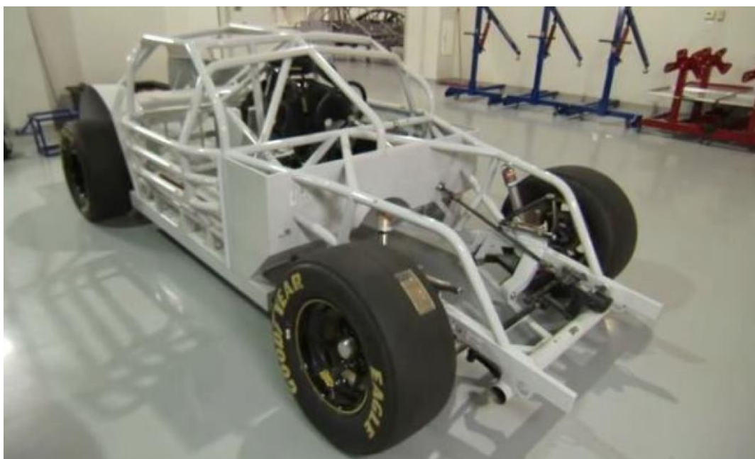
Slika 33: Primjer šasije automobila u NASCAR – u [22]
