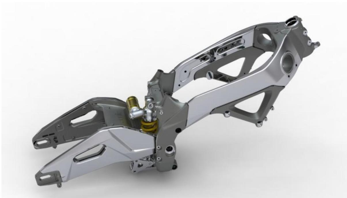
Slika 19: Aluminijска šasija izvedena s mnogo vijčanih spojeva [9]
