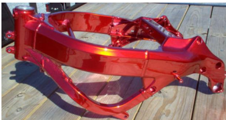
Slika 26: Zaštita šasije praškastim prevlakama [16]
