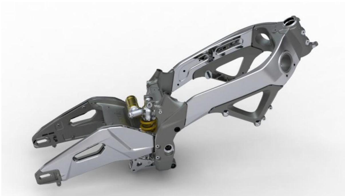
Slika 19: Aluminijska šasija izvedena s mnogo vijčanih spojeva [9]
