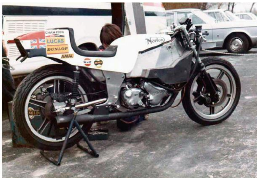
Slika 10: Monocoque šasija John Norton, 1973. godina [1]
