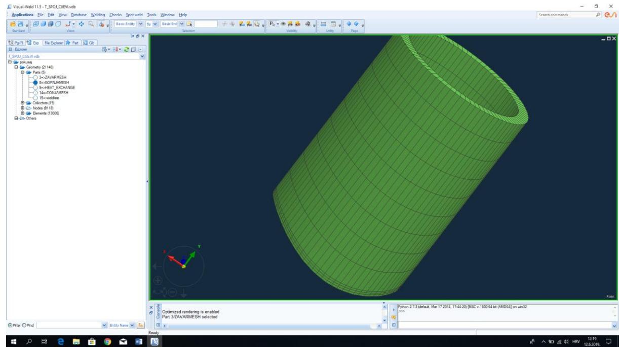
Slika 51: Prikaz mreže elemenata napravljene na gornjoj cijevi
