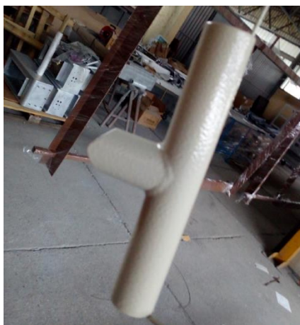
Slika 47: Temeljni sloj Hempadur Zink
