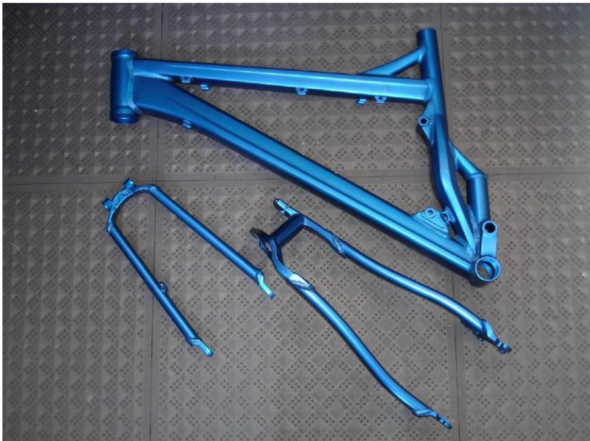
Slika 28: Eloksiranje aluminijске šasije bicikla [18]
