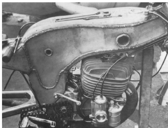
Slika 9: Šasija u T zavarenoj izvedbi, 1960. godina Ossa GP 250cc [1]
