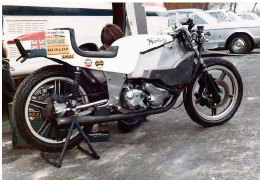
Slika 10: Monocoque šasija John Norton, 1973. godina [1]
