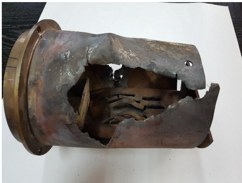
Slika 18. Prikaz oštećenog plamenika s vanjske strane
