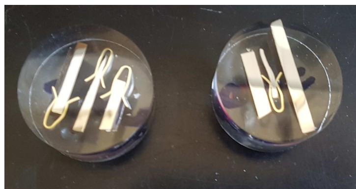
**Slika 29. Uzorci za metalografsko ispitivanje**
