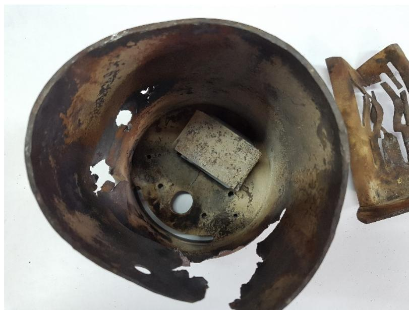
**Slika 19. Prikaz oštećenja unutrašnjosti plamenika**
