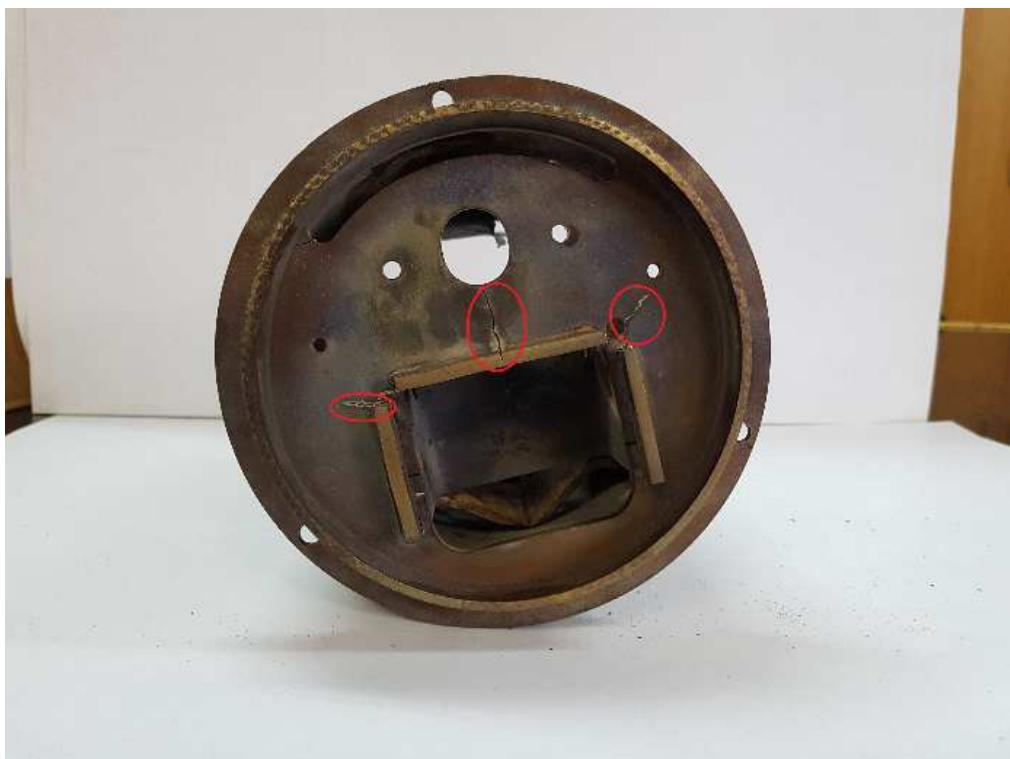
**Slika 20. Prikaz oštećenja plamenika kod ulaza peleta**
