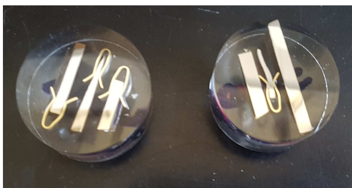
Slika 29. Uzorci za metalografsko ispitivanje
