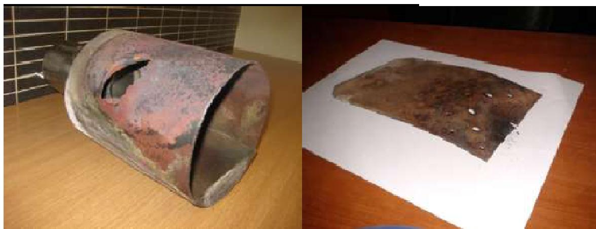
Slika 13. Oštećen plamenik i deformirana rešetka [13]
