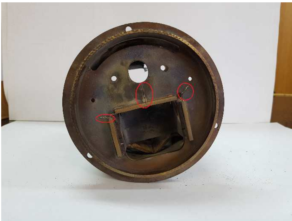
Slika 20. Prikaz oštećenja plamenika kod ulaza peleta
