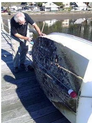
Slika 18: Obrasli gaz plovila.
