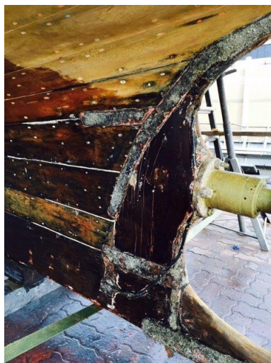
Slika 16: Utjecaj korozije na drvenu konstrukciju.
