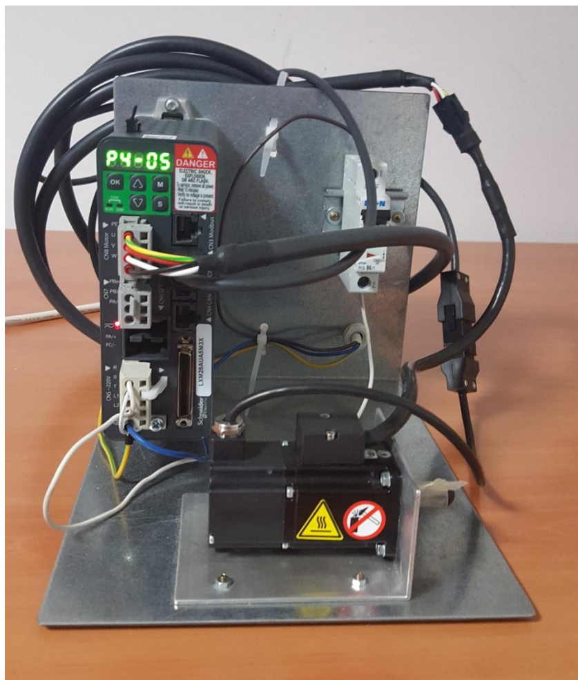
Slika 6. Fotografija eksperimentalnog postava servomotora s pretvaračem
