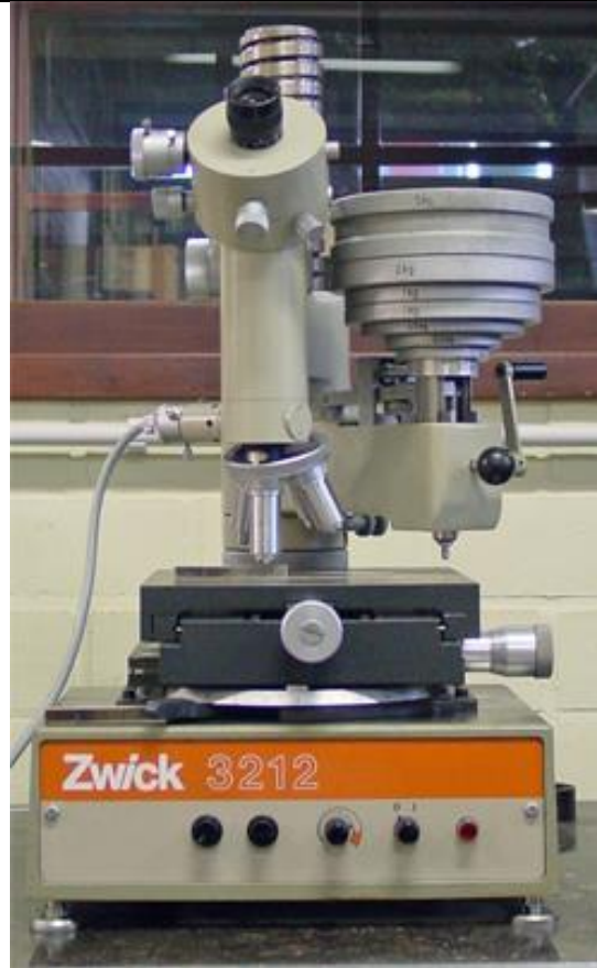
Slika 20 Primjer korištenog tvrdomjera kod laboratorija 2
