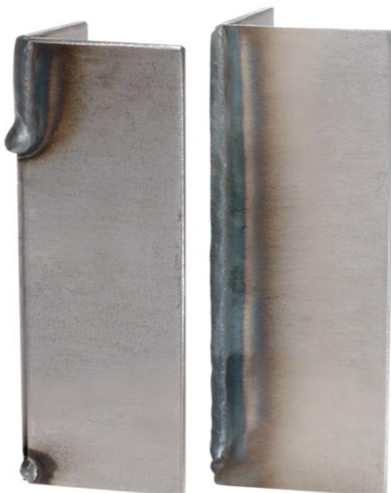
Slika 17. Rubni spoj čelika S235; izrađen konvencionalnim prijenosom metala kratkim spojevima (lijevo) i SpeedCold postupkom (desno) [28]
