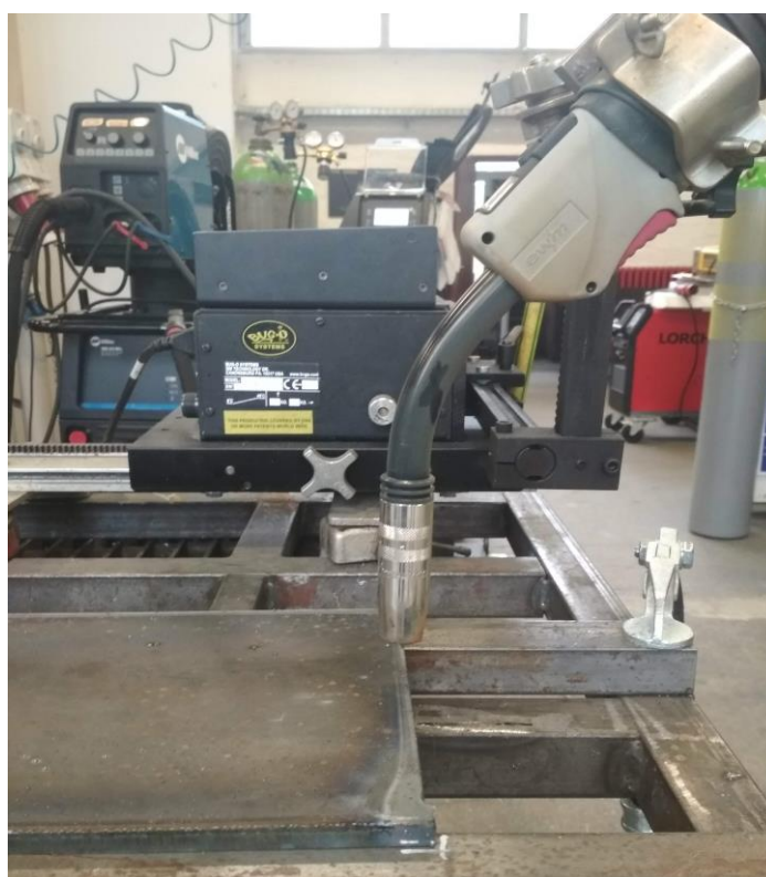
Slika 52. Položaj pištolja – neutralna tehnika rada
