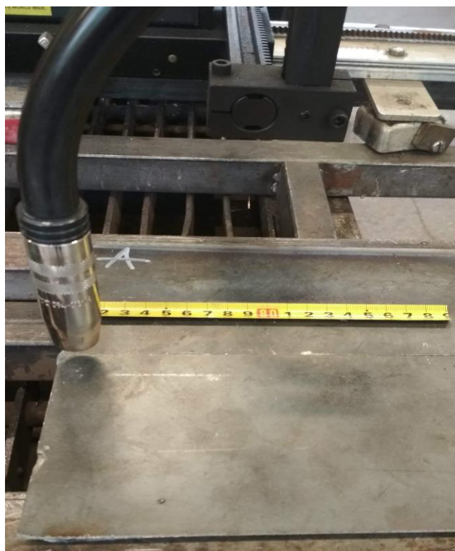
Slika 67. Prikaz položaja pištolja tijekom zavarivanja sučeljenog spoja
