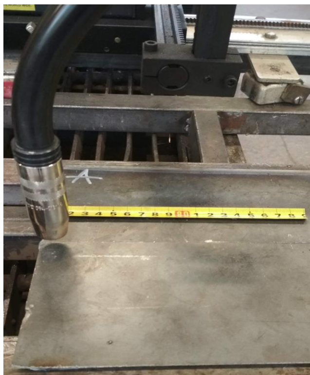
Slika 67. Prikaz položaja pištolja tijekom zavarivanja sučeljenog spoja
