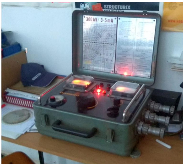
Slika 40. Upravljačko sučelje uređaja BALTEAU GM 300D
