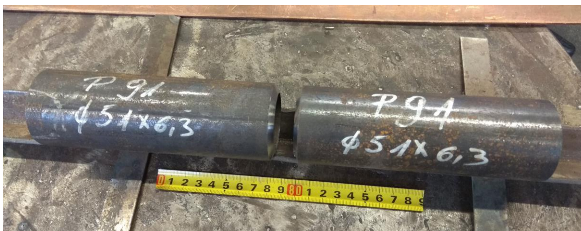
Slika 27. Izgled cijevi prije zavarivanja
