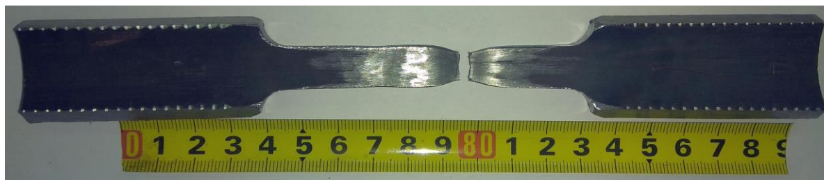
Slika 52. Uzorak 2 nakon statičkog vlačnog ispitivanja
