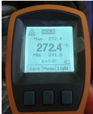
Slika 35. Mjerenje međuprolazne temperature
