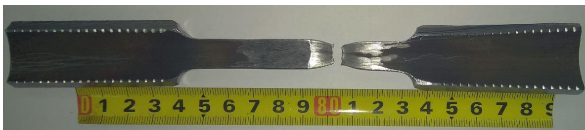
Slika 51. Uzorak 1 nakon statičkog vlačnog ispitivanja
