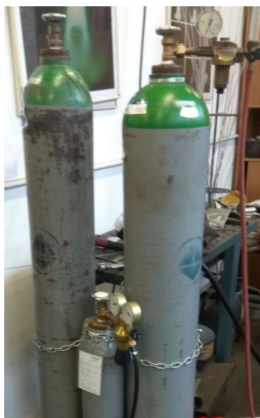
Slika 28. Čelične boce s korištenim zaštitnim plinovima
