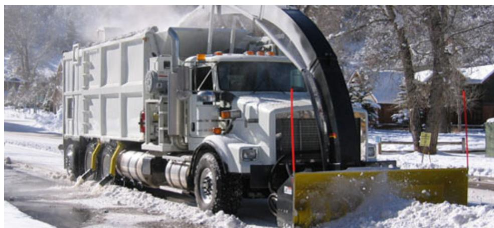
**Slika 9. Mobile Snowmelter SRS-M150**
