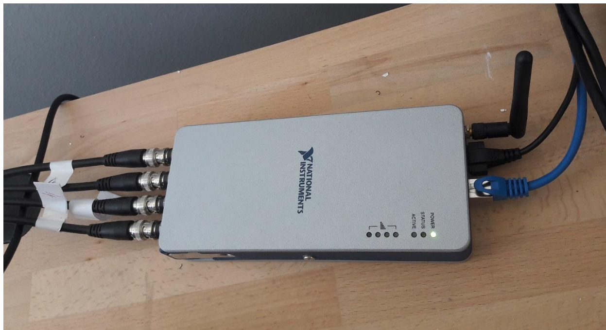
Slika 21. National Instruments NI 9191+NI9234
