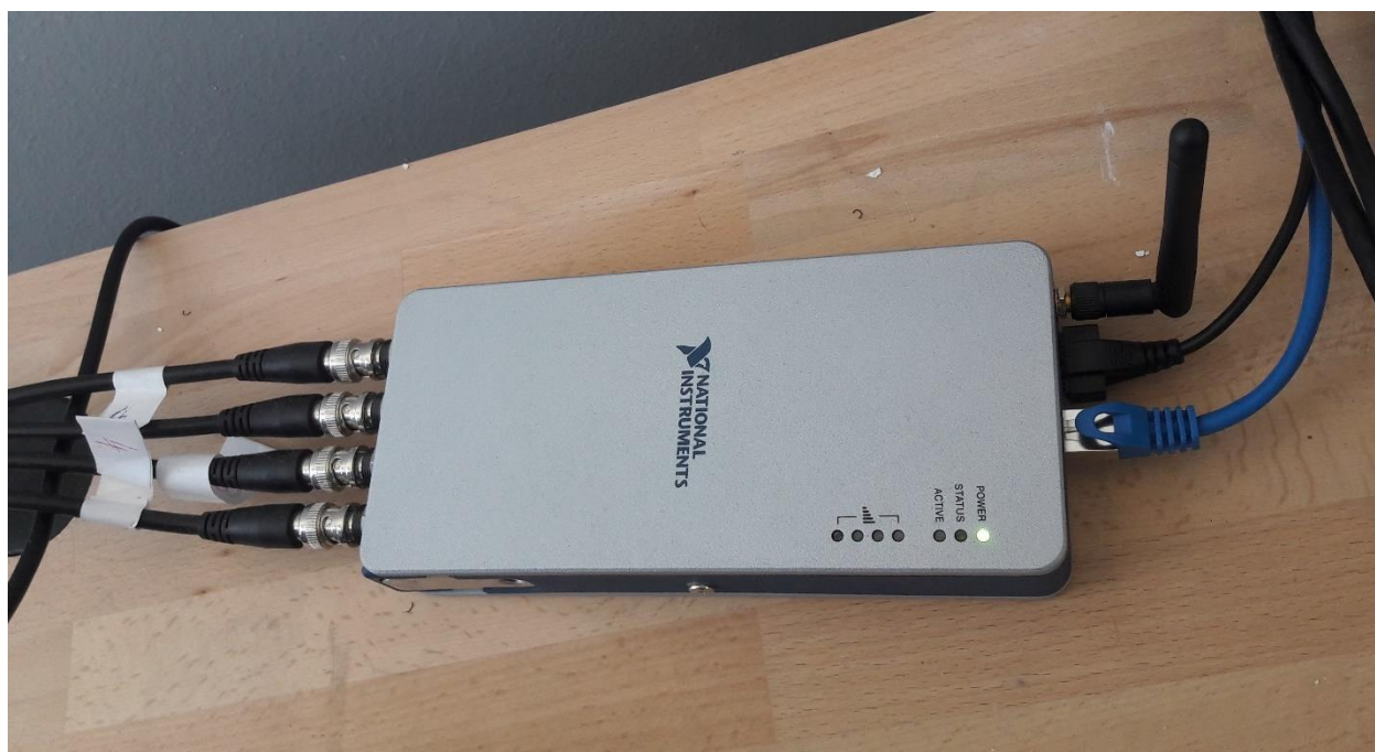
Slika 21. National Instruments NI 9191+NI9234
