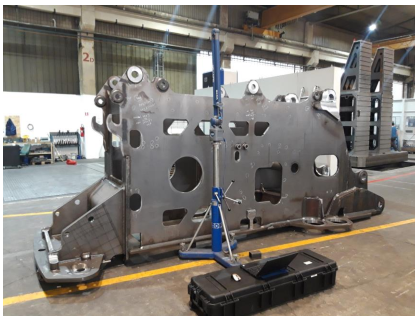
Slika 9 Prikaz trodimenzionalnog mjerenja mjernom rukom „FARO Arm“
