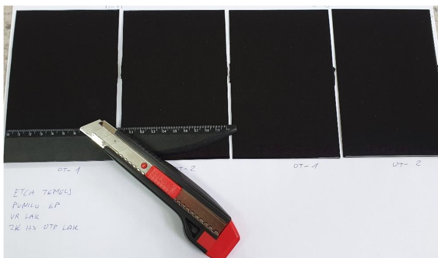
Slika 32. Uzorci pripremljeni za ispitivanje u slanoj komori
