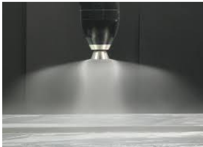
Slika 8. Elektrostatički rotirajući atomizer [17]
