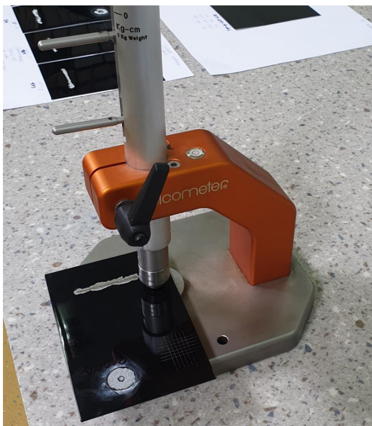
Slika 44. Ispitivanje otpornosti premaza na udar
