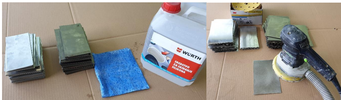
Slika 19. Priprema uzoraka prije nanošenja premaza
