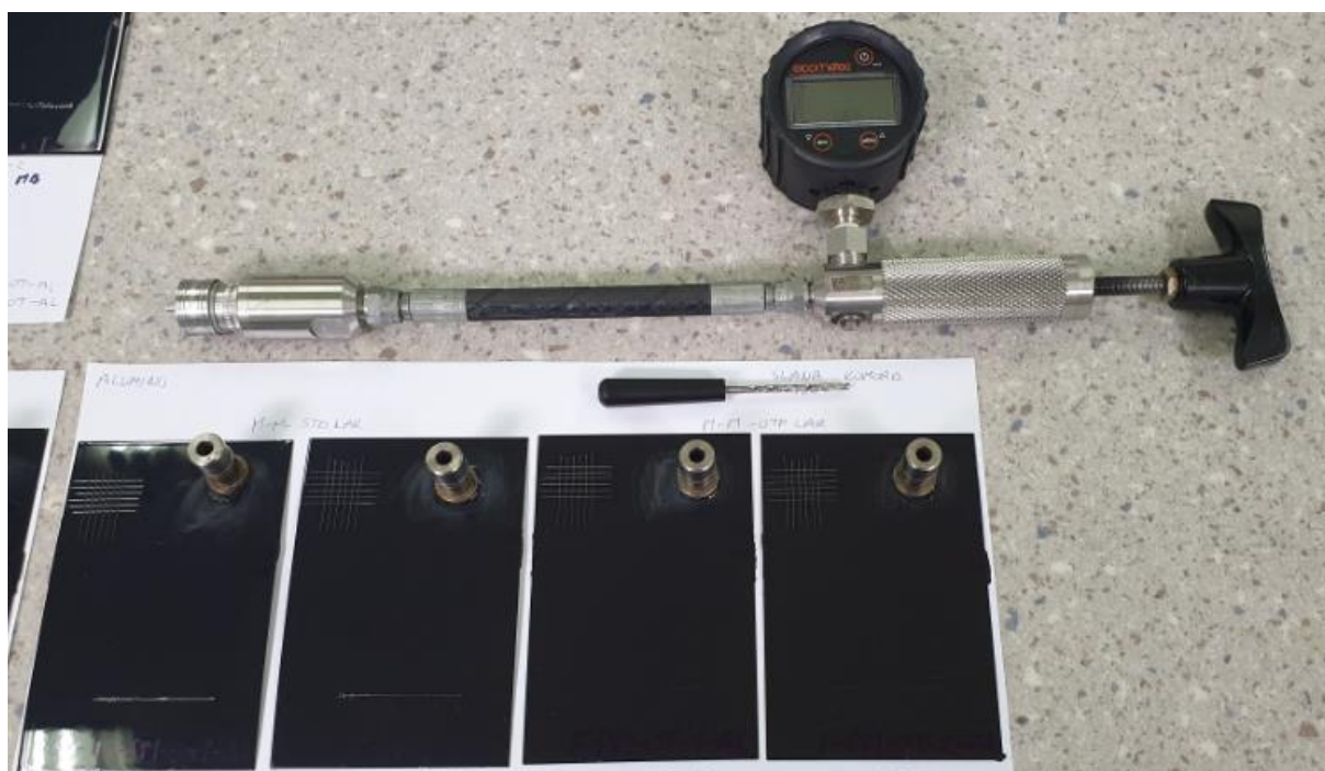
Slika 38. Lijepljenje testnih valjčića i uređaj za ispitivanje
