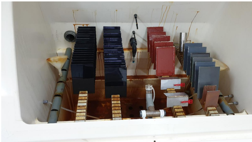
Slika 31. Ispitivanje uzoraka u slanoj komori
