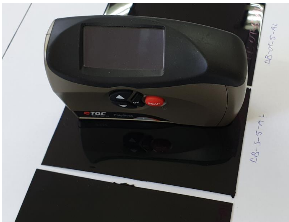
Slika 24. Uređaj za ispitivanje sjaja premaza
