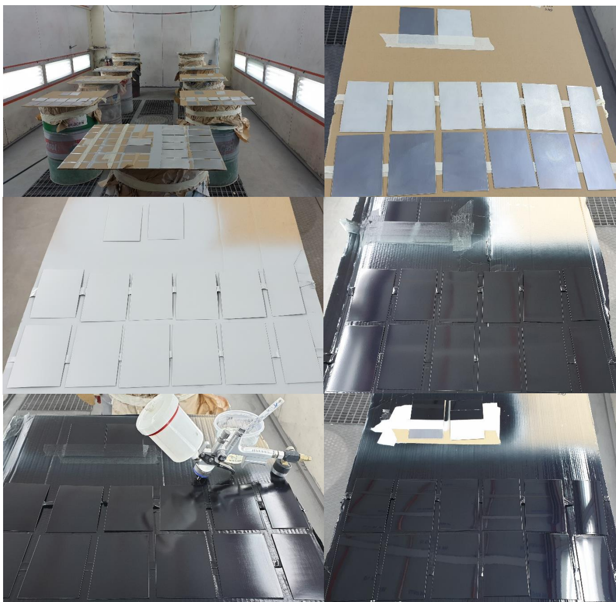
Slika 21. Koraci nanošenja premaza, lakirnica tvrtke Autousluga d.o.o.
