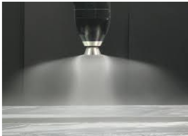
Slika 8. Elektrostatički rotirajući atomizer [17]
