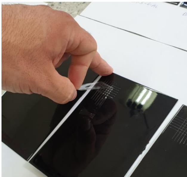
Slika 37. Uklanjanje ljepljive trake
