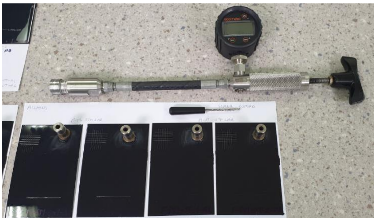
Slika 38. Lijepljenje testnih valjčića i uređaj za ispitivanje
