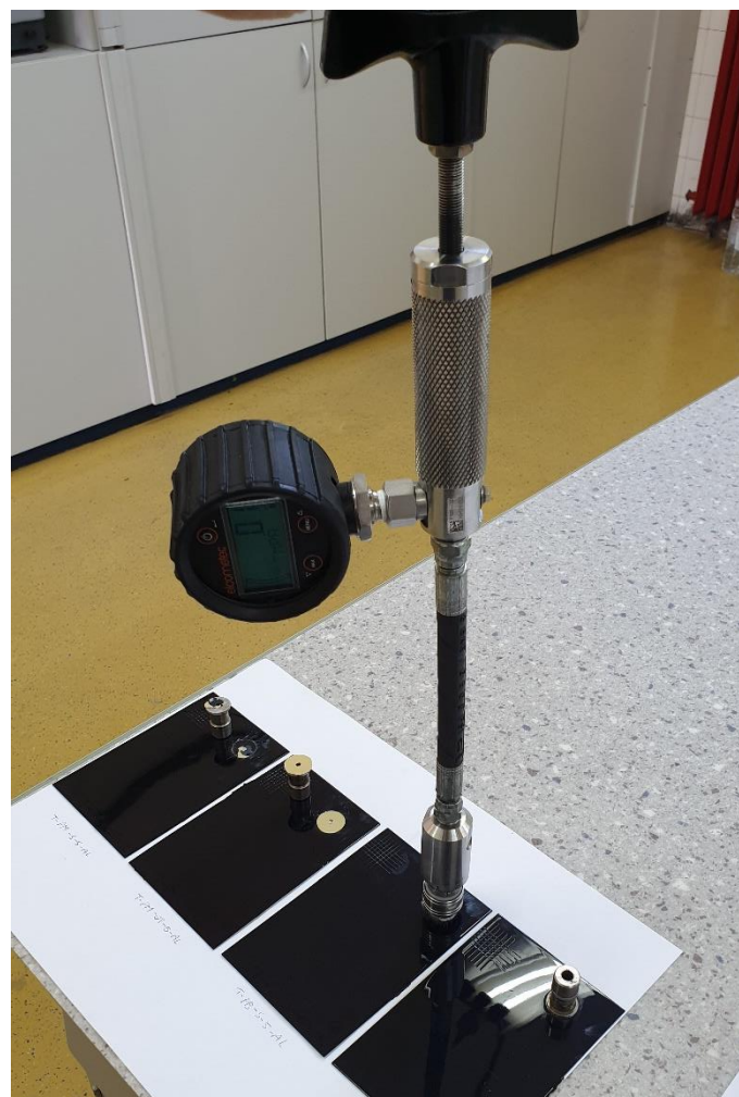
Slika 40. Ispitivanje prionjivosti Pull-off testom
