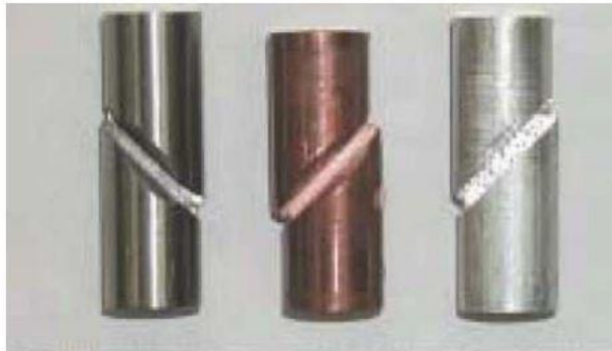
Slika 39. Uzorci za ispitivanja smika i tlaka nakon ispitivanja [42]
