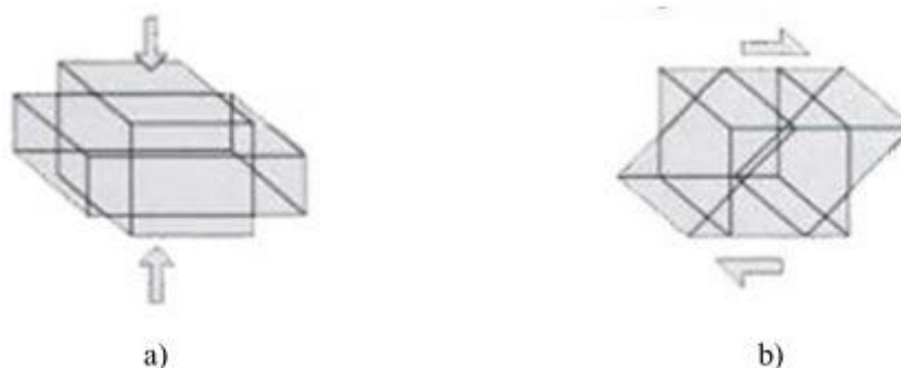
Slika 34. Primjer: a) čistog i b) jednostavnog smika [38]
