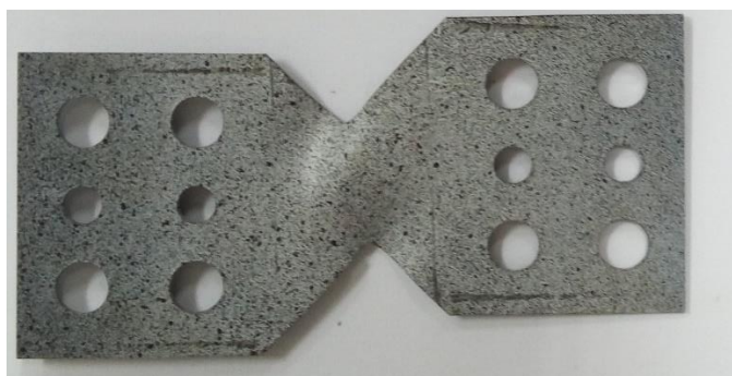
Slika 82. Deformirani ispitni uzorak E2
