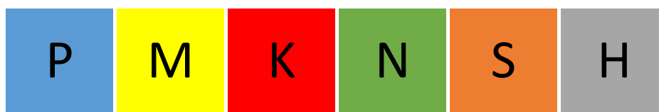
Slika 17. Označavanje reznih alata prema materijalu obratka
